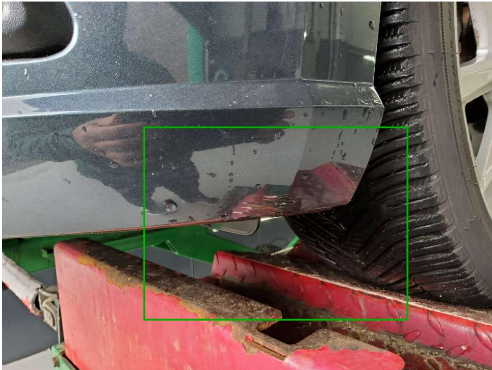
Bild 15 : Stoßfänger vorne links, verschrammt
