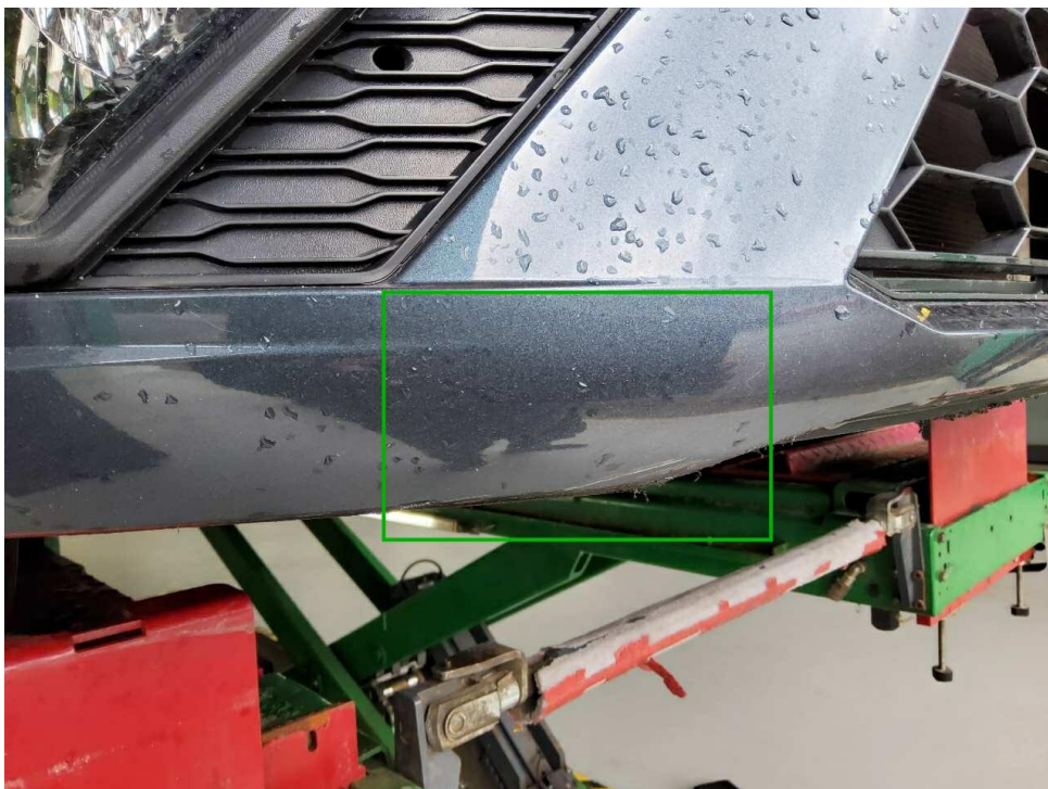
Bild 16 : Stoßfänger vorne, verschrammt
