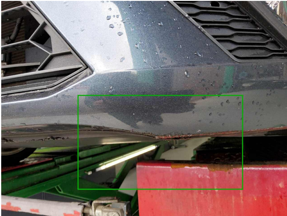
Bild 17 : Stoßfänger vorne, verschrammt
