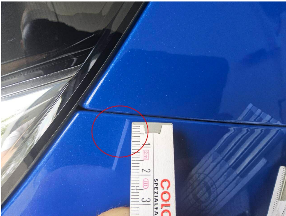
Bild 14 : Stoßstange vorne vereinzelt Steinschlag
