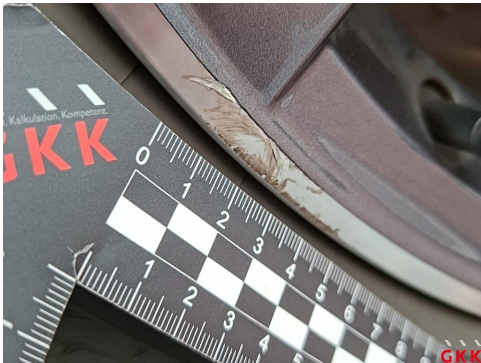
Bild 30. LM-Rad, hinten rechts, beschädigt, ersetzen
