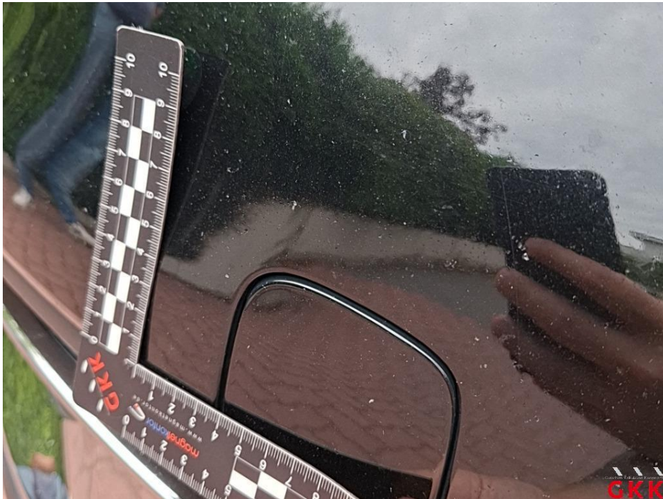
Bild 22. Stoßfänger vorne, Verkleidung -lackiert-, Steinschlag, lackieren
