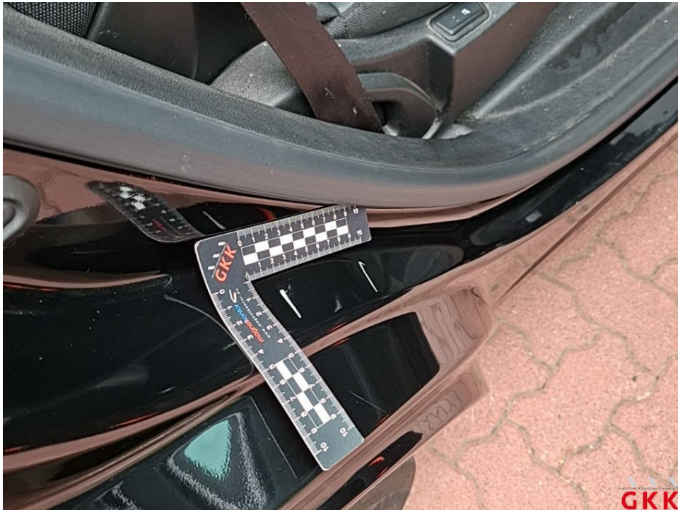
Bild 26. Tür hinten rechts, Einstieg, beschädigt, instand setzen - lackieren
