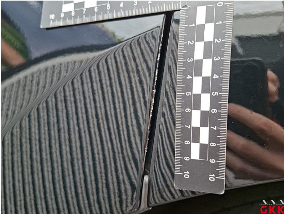
Bild 17. Tür hinten links, Kante, verkratzt, auslegen, schleifen, polieren
