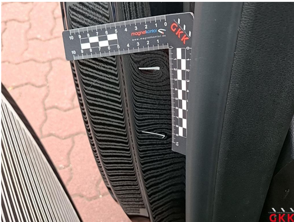
Bild 28. Tür hinten rechts, Einstieg, beschädigt, instand setzen - lackieren
