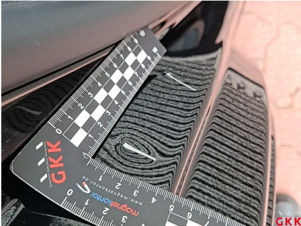
Bild 27. Tür hinten rechts, Einstieg, beschädigt, instand setzen - lackieren
