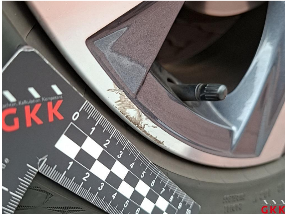
Bild 29. LM-Rad, hinten rechts, beschädigt, ersetzen
