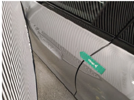
Tür / Vorne Links / Delle
