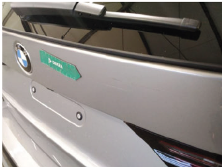
Heckklappe / Kofferraumtür / Mitte Mitte / Kratzer
