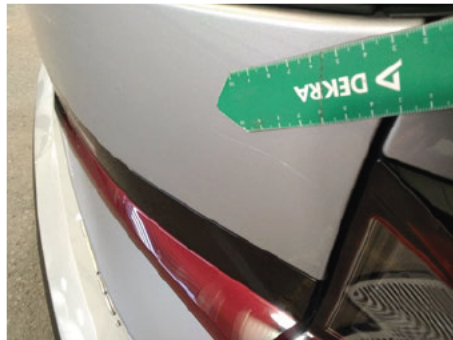
Heckklappe / Kofferraumtür / Mitte Mitte / Kratzer
