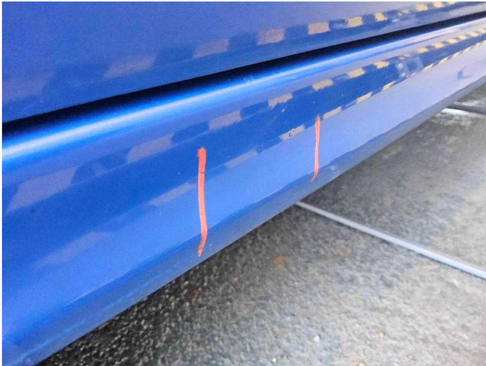
Bild 13 : Seitenschweller links, korrodiert, smart repair
