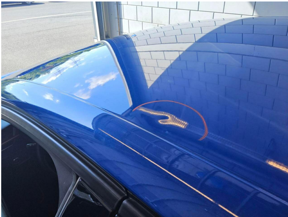
Bild 14 : Dach, eingedellt, drücken
