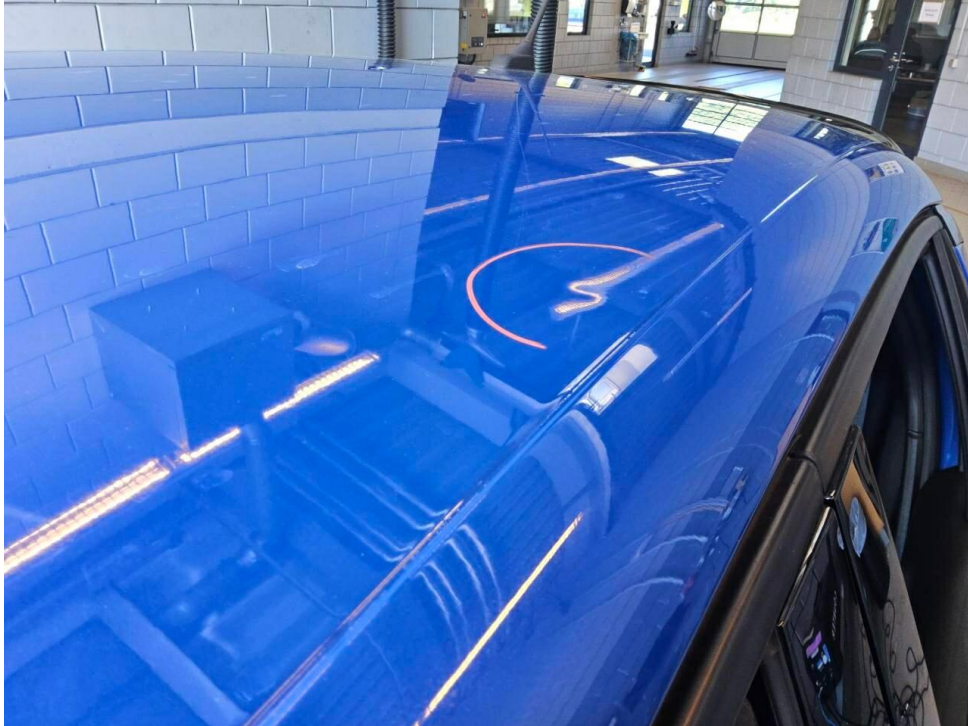
Bild 15 : Dach, eingedellt, drücken
