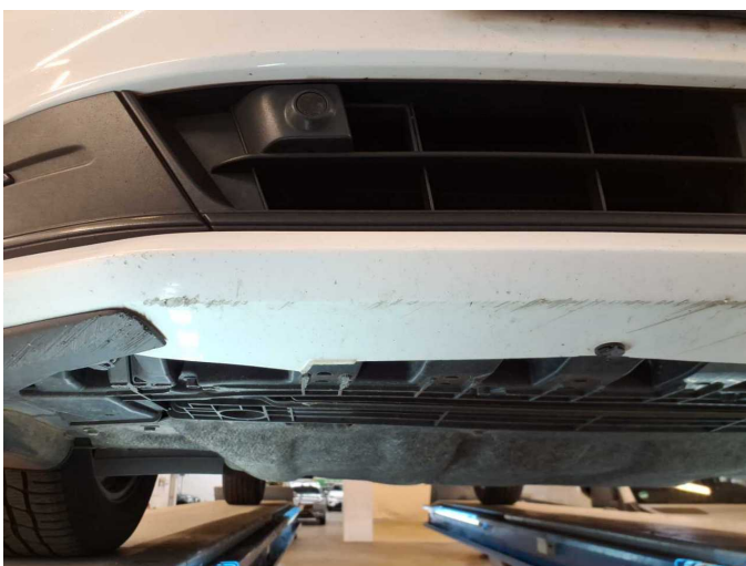
Damage 6: Front bumper: Front bumper (+ Spoiler rechts erneuern) - Scratch(es) - Paint
