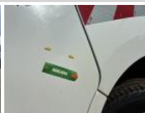
Door trim RR, Scratch(es), Replace
