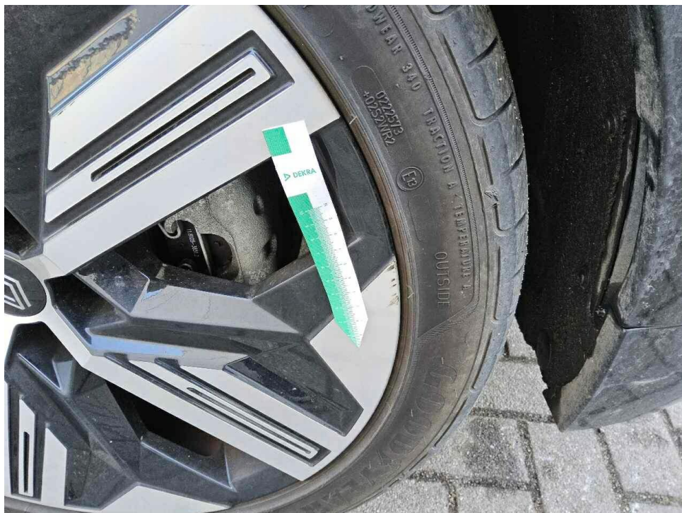
Bild 14 : glanzgedrehte Felge vorne rechts, Kratzer
