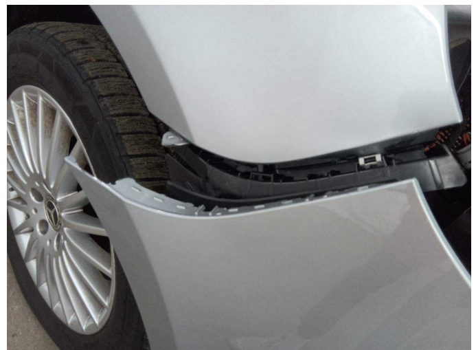
Damage 7: Front bumper: Front bumper (inkl. Halter links + rechts erneuern) - Broken / torn - Replace
