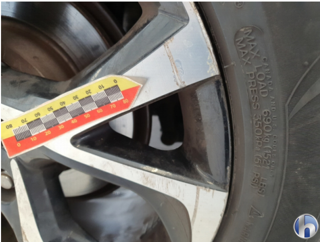
5. Felge Hinten - Rechts Kratzer - Smart Repair 100,00 € / 100,00 €
