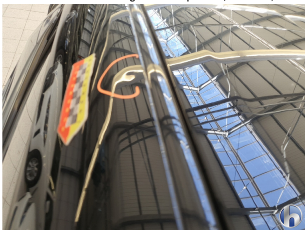
14. Dachrahmen - Rechts 1 Delle - Sanft Instandsetzen 85,00 € / 85,00 €
