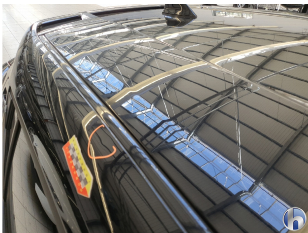
14. Dachrahmen - Rechts 1 Delle - Sanft Instandsetzen 85,00 € / 85,00 €
