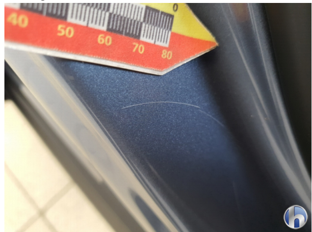
1. Türeinstieg Vorne - Rechts Kratzer - Smart Repair 150,00 € / 150,00 €
