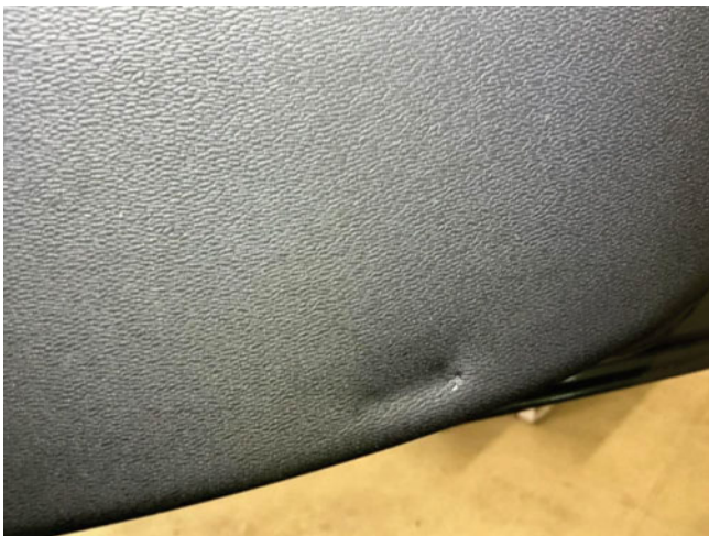
Türverkleidung vo re - gebrochen - erneuern
