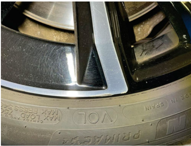
Felge Sommerrad vo re - zerkratzt - SmartRepair
