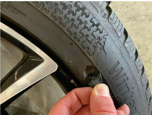
Winterreifen hi li - beschädigt - erneuern
