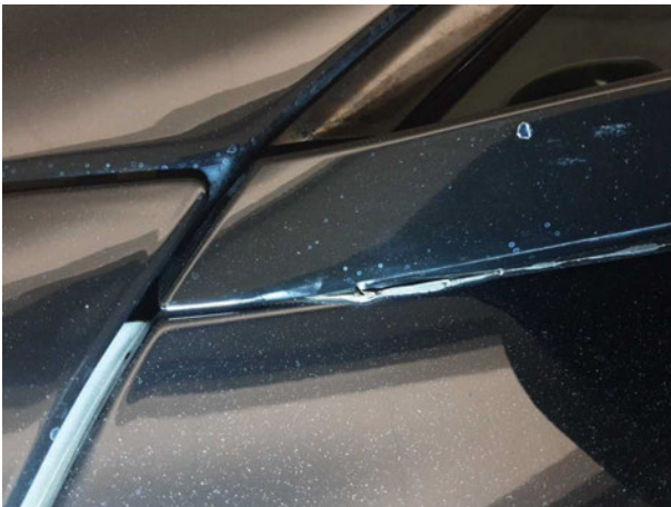
Beschädigung #4: Außenspiegel links: Spiegelgehäuse - gebrochen / gerissen - erneuern
