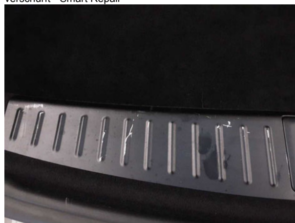
Beschädigung #2: Verkleidungen/Abdeckungen: Verkleidung Ladekante - verkratzt / verschürft - erneuern
