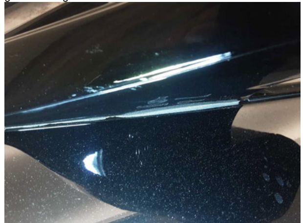
Beschädigung #4: Außenspiegel links: Spiegelgehäuse - gebrochen / gerissen - erneuern
