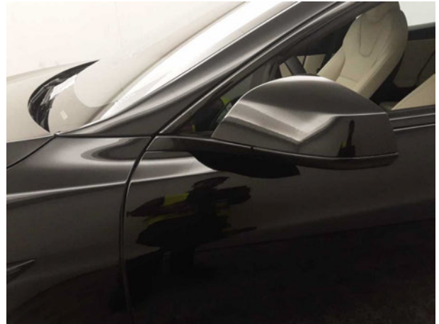
Beschädigung #4: Außenspiegel links: Spiegelgehäuse - gebrochen / gerissen - erneuern
