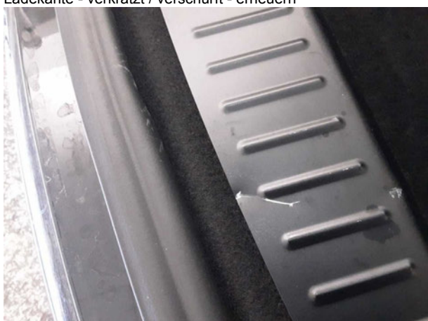
Beschädigung #2: Verkleidungen/Abdeckungen: Verkleidung Ladekante - verkratzt / verschürft - erneuern
