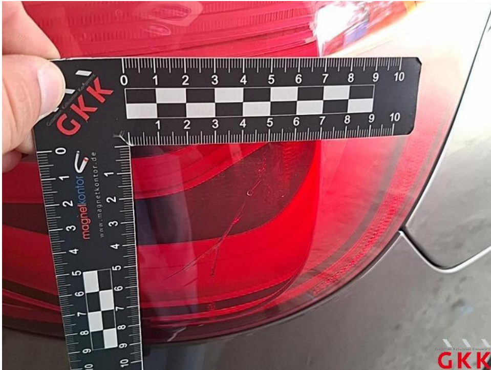
Bild 41. Rückleuchte rechts, außen, gerissen, ersetzen
