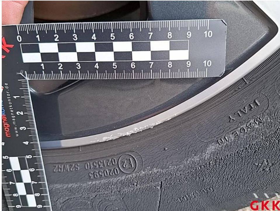
Bild 43. LM-Rad, vorne rechts, Materialabtrag, ersetzen
