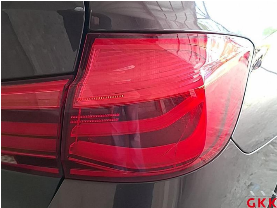
Bild 40. Rückleuchte rechts, außen, gerissen, ersetzen
