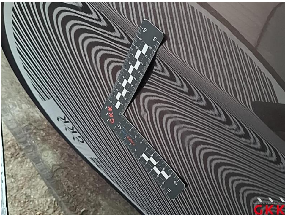
Bild 36. Tür hinten links, bis 3 Dellen / Bauteil, instand setzen - lackieren
