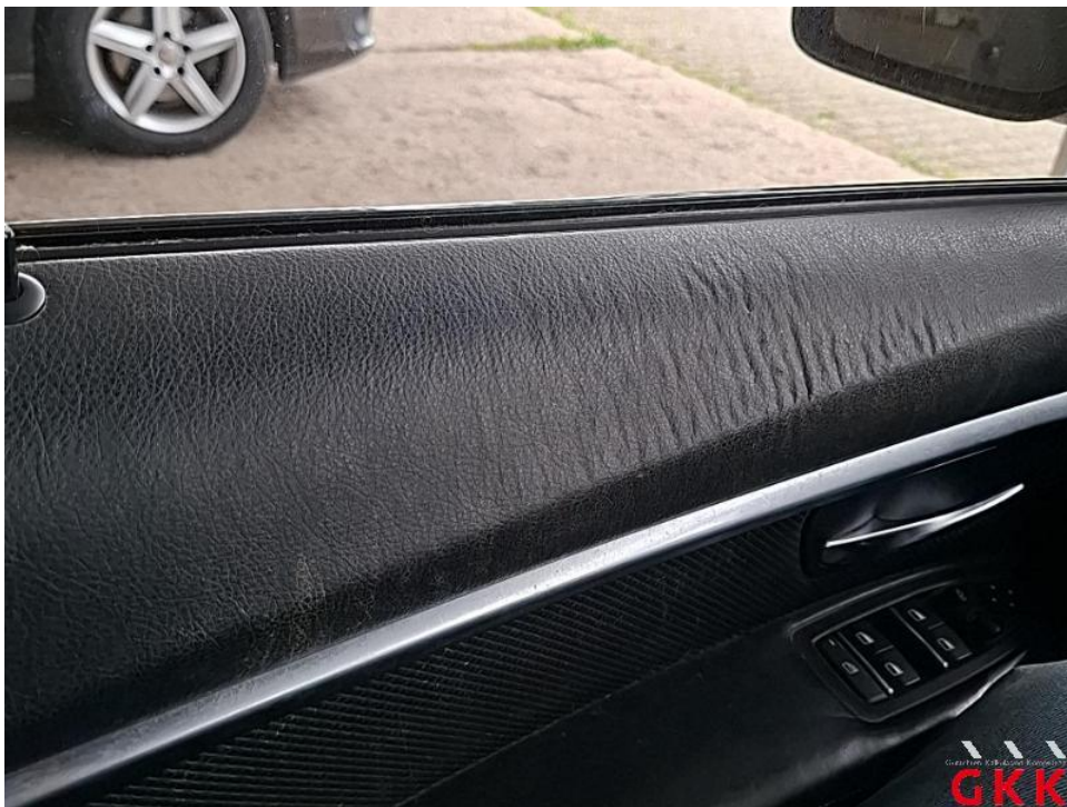
Bild 16. Tür vorne links, Innenverkleidung -Standard-, beschädigt, ersetzen
