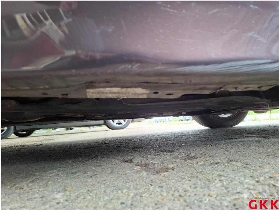
Bild 29. Schweller rechts, Verkleidung -lackiert-, beschädigt, ersetzen
