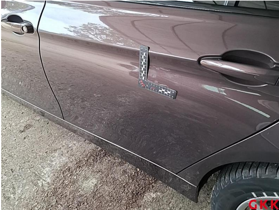
Bild 35. Tür hinten links, bis 3 Dellen / Bauteil, instand setzen - lackieren
