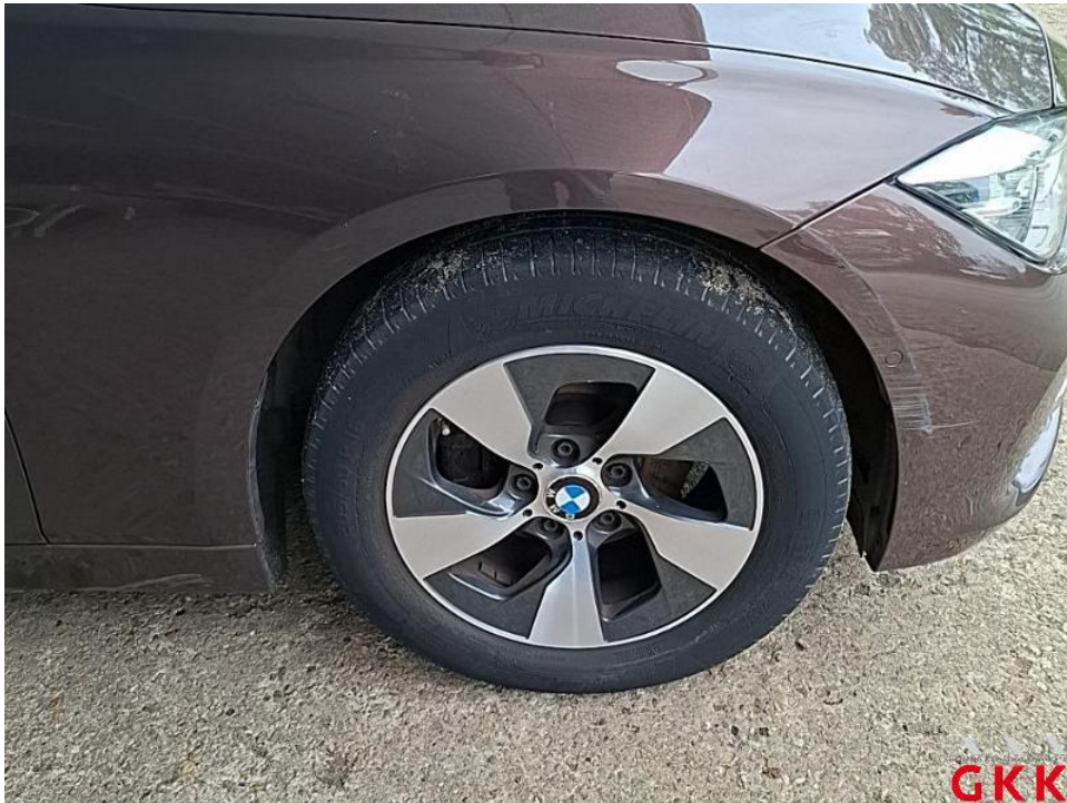
Bild 42. LM-Rad, vorne rechts, Materialabtrag, ersetzen
