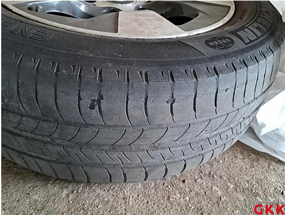
Bild 39. Reifen, 1 x beiliegend, beschädigt, ersetzen
