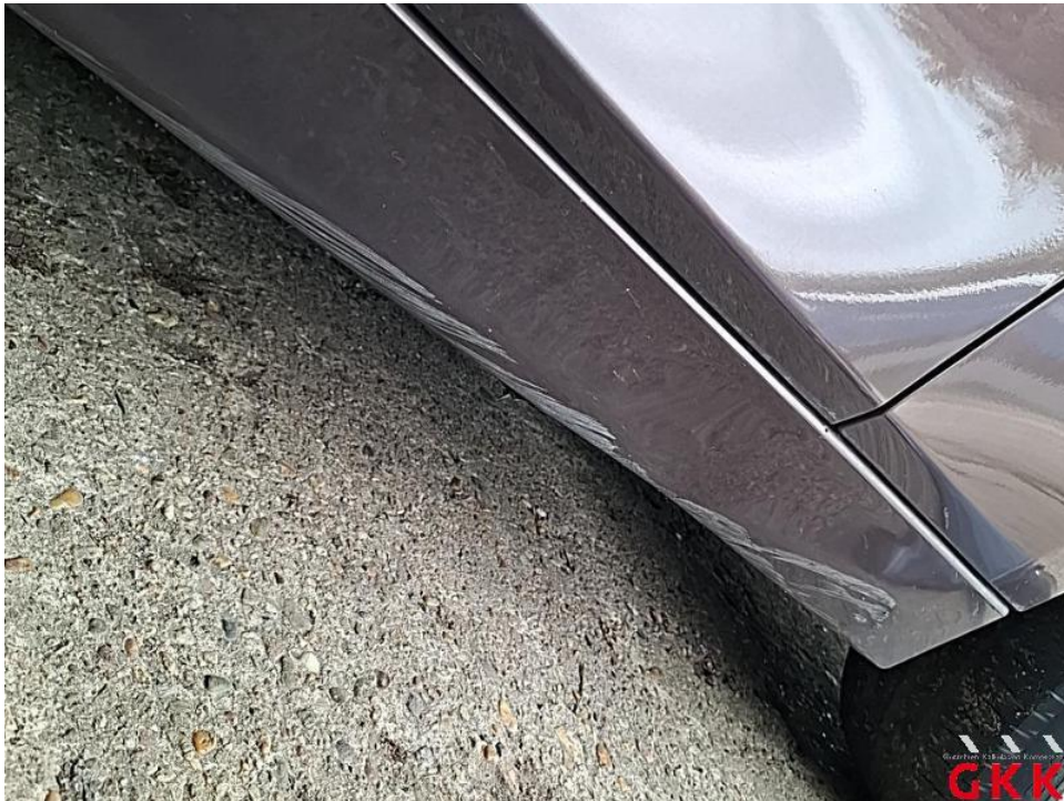
Bild 28. Schweller rechts, Verkleidung -lackiert-, beschädigt, ersetzen
