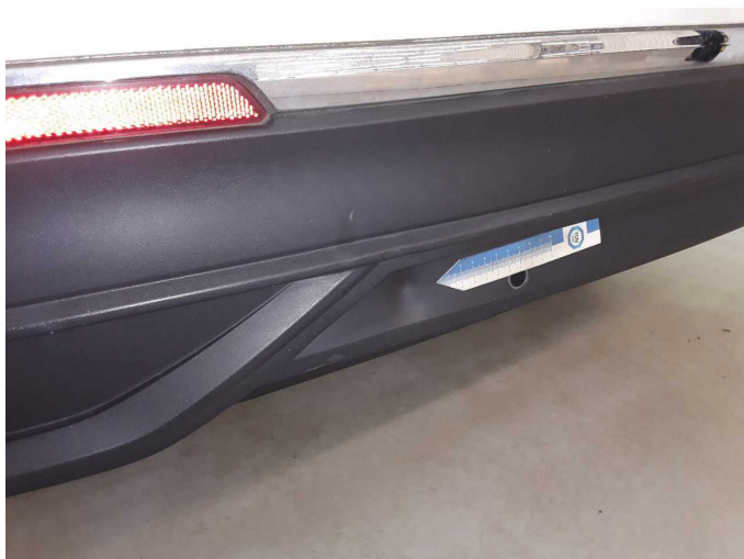
Damage 6: Rear bumper: Spoiler (unlackiert) - dent(s) - Replace
