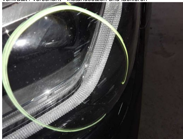
Beschädigung #9: Scheinwerfer: LED-Scheinwerfer links - verkratzt / verschürft - erneuern
