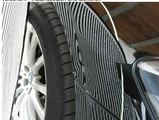
Beschädigung #7: Kotflügel rechts: Kotflügel rechts - Delle / Lackschaden - instandsetzen und lackieren
