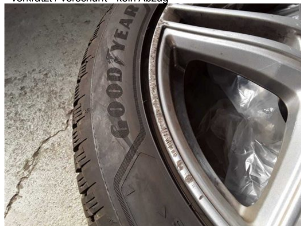
Beschädigung #1: 2.Radsatz: Leichtmetallfelgensatz komplett - verkratzt / verschürft - kein Abzug
