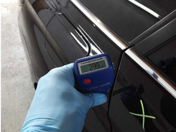
Nachlackierung 1: Seitenwand rechts, Tür hinten rechts
