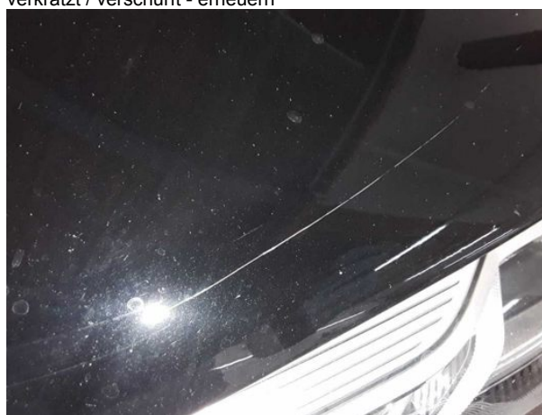
Beschädigung #10: Motorhaube: Motorhaube - verkratzt / verschürft - instandsetzen und lackieren
