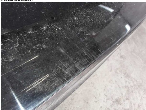
Beschädigung #3: Stossfänger hinten: Stossfänger hinten - Kratzer - Wertminderung
