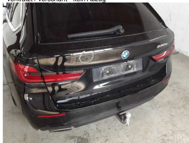
Beschädigung #2: Heckklappe/-tür: Heckklappe - Delle(n) - sanft instandsetzen
