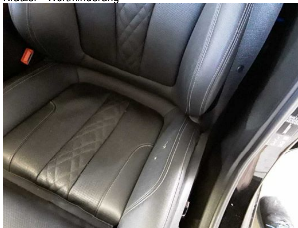
Beschädigung #4: Sitz vorn: Sitzbezug links - gebrochen / gerissen - erneuern
