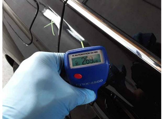
Nachlackierung 1: Seitenwand rechts, Tür hinten rechts
