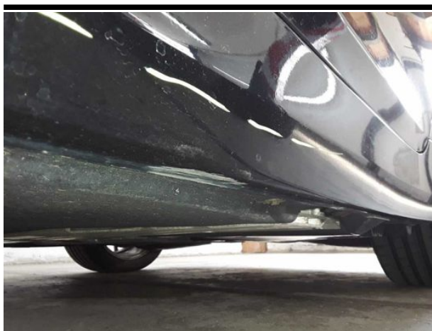
Beschädigung #5: Schweller links: Verkleidung - verkratzt / verschürft - instandsetzen und lackieren
