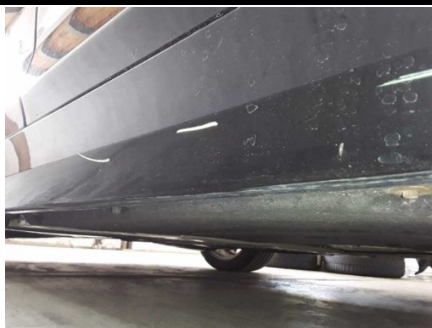
Beschädigung #6: Schweller rechts: Verkleidung - verkratzt / verschürft - instandsetzen und lackieren
