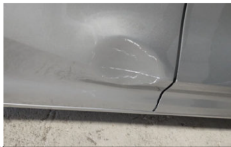
Tür / Hinten Rechts / Delle
