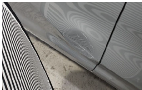
Tür / Hinten Rechts / Delle
