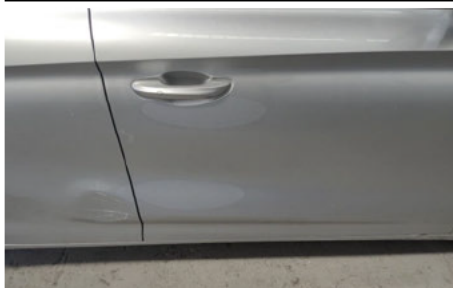
Türgriff Außen / Vorne Rechts / Kratzer
