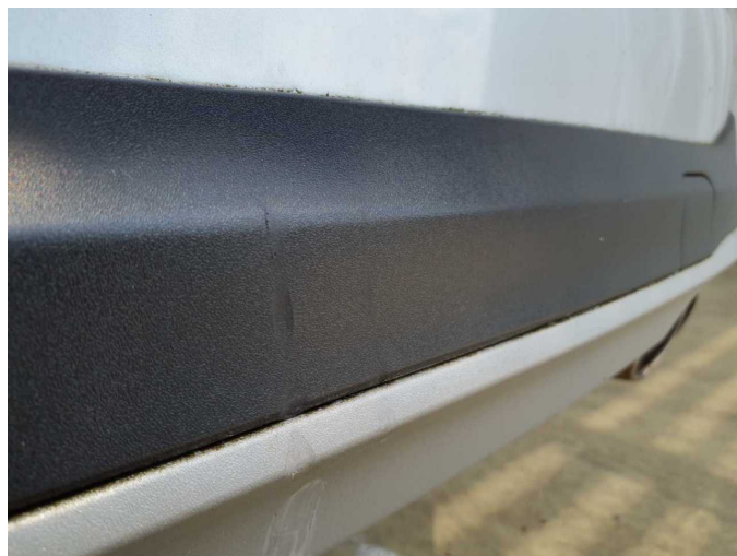
Damage 8: Rear bumper: Rear bumper (Zusätzlich Spoiler und Blende Kratzer) - Scratched - Paint
