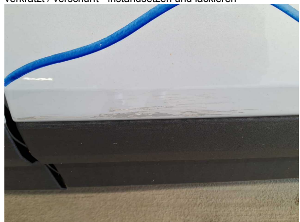
Beschädigung #7: Tür hinten links: Tür - verkratzt / verschürft... instandsetzen und lackieren
