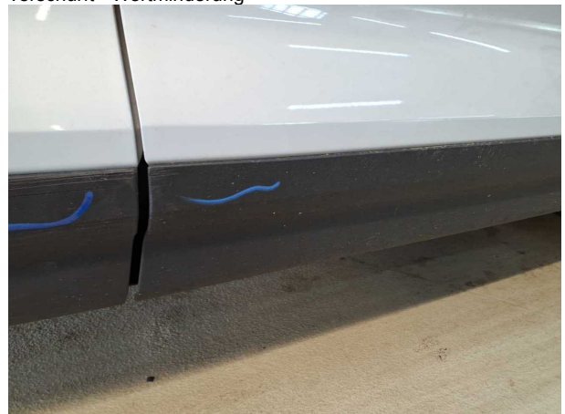
Beschädigung #3: Tür vorn rechts: Zierleiste unten - verkratzt / verschürft - erneuern
