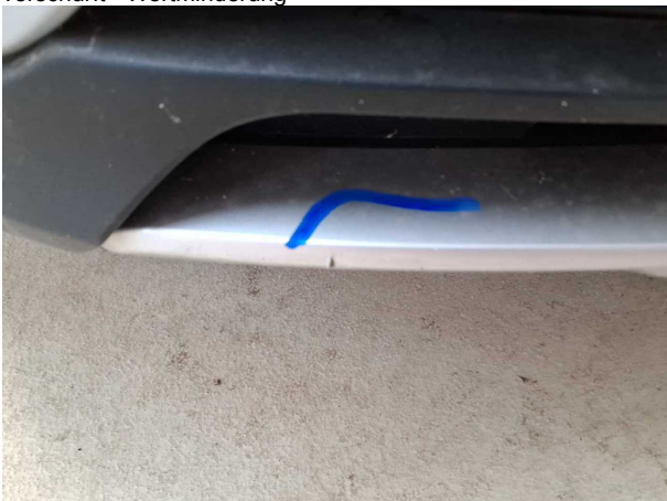
Beschädigung #2: Stossfänger vorn: Spoiler - verkratzt / verschürft - Wertminderung
