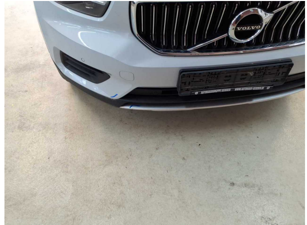
Beschädigung #2: Stossfänger vorn: Spoiler - verkratzt / verschürft - Wertminderung
