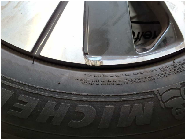
Beschädigung #1: 2.Radsatz: 1 Leichtmetallfelge - verkratzt / verschürft - Wertminderung
