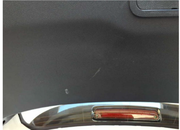
Beschädigung #1: Verkleidungen/Abdeckungen: Heckdeckel, Innenverkleidung - Kratzer - Smart Repair
