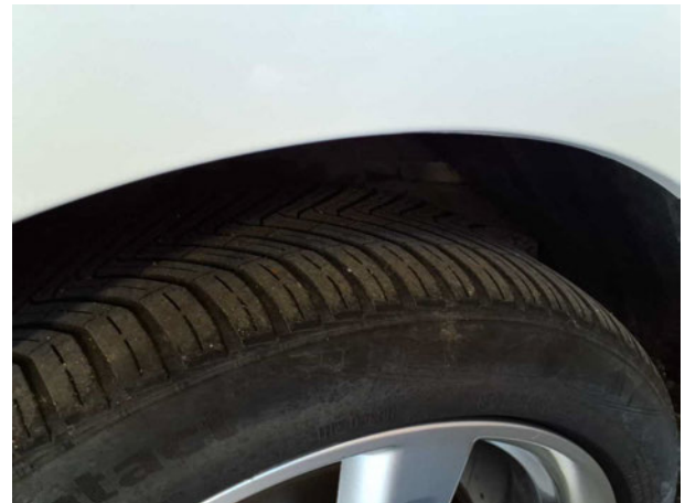
Beschädigung #5: Rad/Reifen: Reifen vorn (Profiltiefe <4mm) - entspricht nicht den Leasingvorgaben - erneuern
