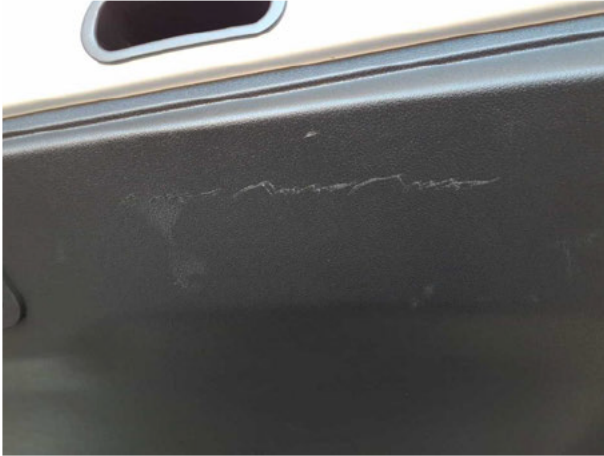
Beschädigung #1: Verkleidungen/Abdeckungen: Heckdeckel, Innenverkleidung - Kratzer - Smart Repair
