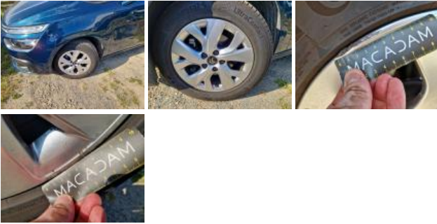
Alloy rim RL, Scratch(es), Repair/replace (lump sum)
