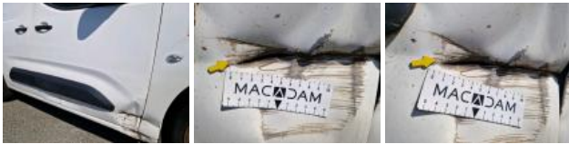
Door trim FR, Scratch(es), Replace
