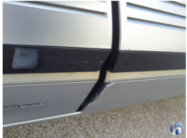
1. Tür Vorne - Rechts Riss - Erneuern
