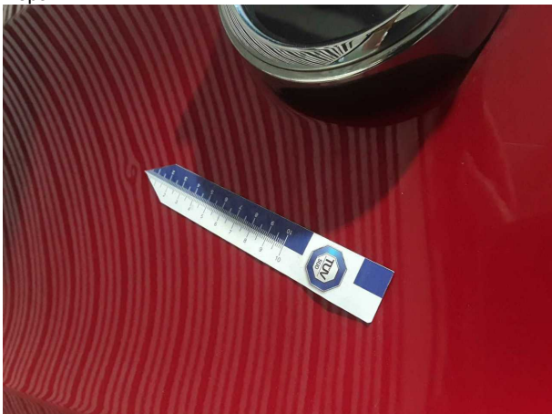
Beschädigung #1: Heckklappe/-tür: Heckklappe - Delle(n) - Smart Repair
