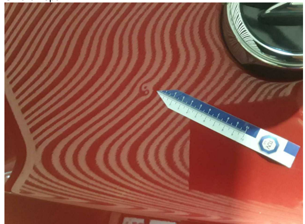
Beschädigung #1: Heckklappe/-tür: Heckklappe - Delle(n) - Smart Repair
