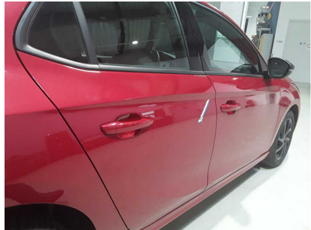
Beschädigung #4: Tür hinten rechts: Tür - Korrosion - instandsetzen und lackieren
