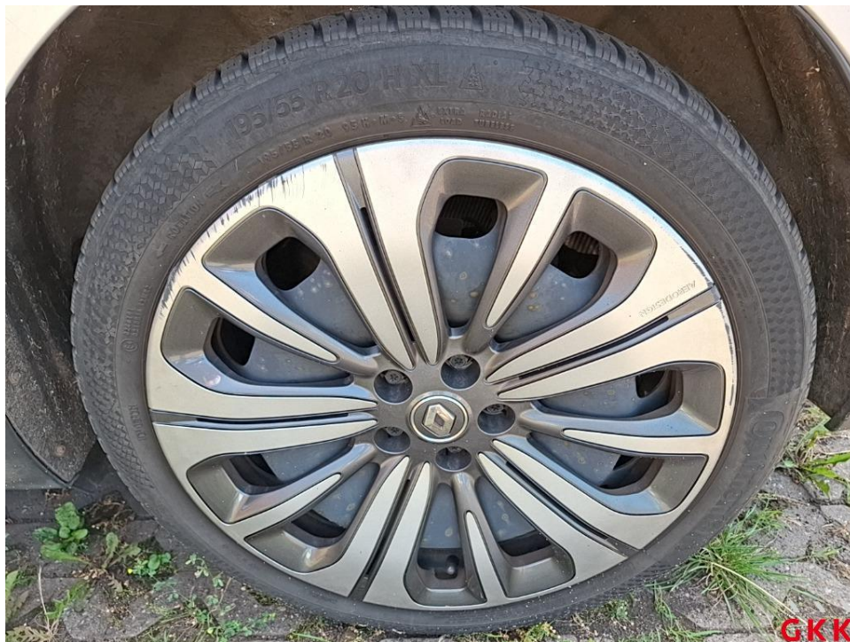
Bild 16. Radkappe(n), Satz, beschädigt, ersetzen
