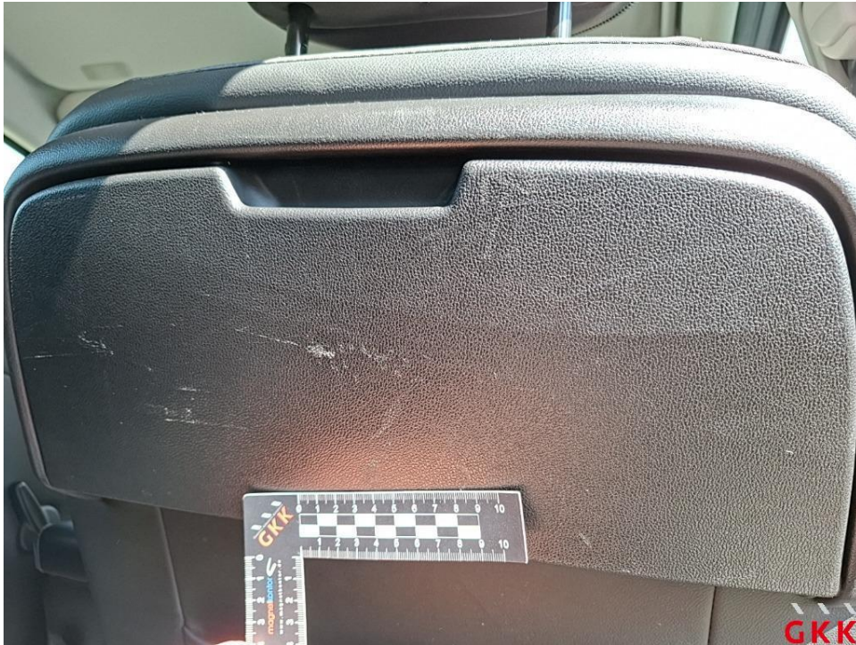
Bild 47. Sitz vorne rechts, Verkleidung, verkratzt, ersetzen
