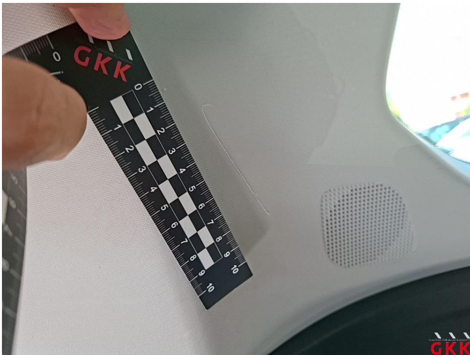
Bild 42. D- Säule links, Innenverkleidung, verkratzt, ersetzen
