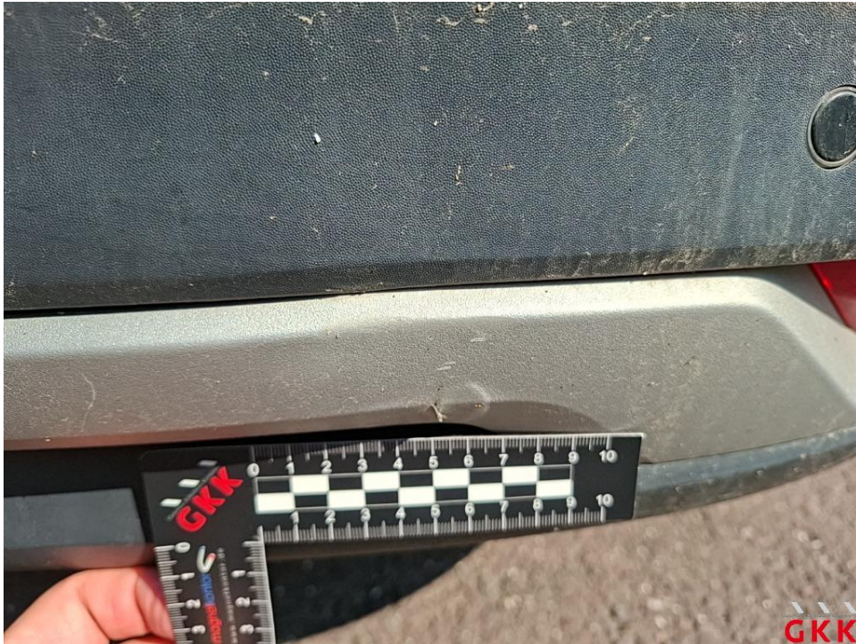
Bild 37. Stoßfänger hinten, Verkleidung unterhalb -unlackiert-, beschädigt, ersetzen
