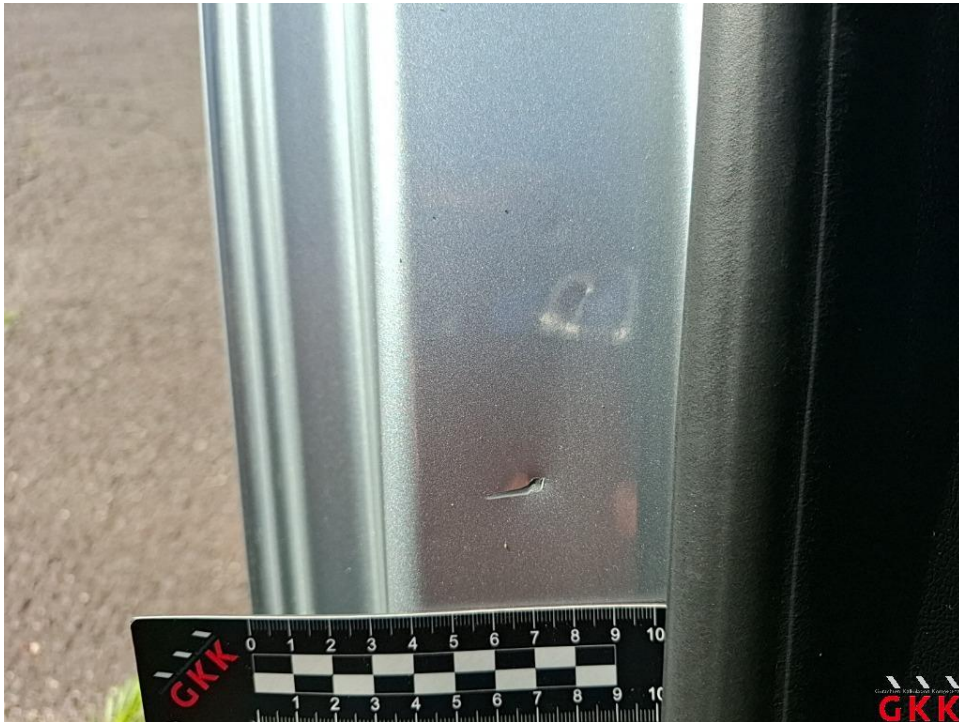
Bild 44. Tür hinten rechts, Einstieg, beschädigt, instand setzen - lackieren
