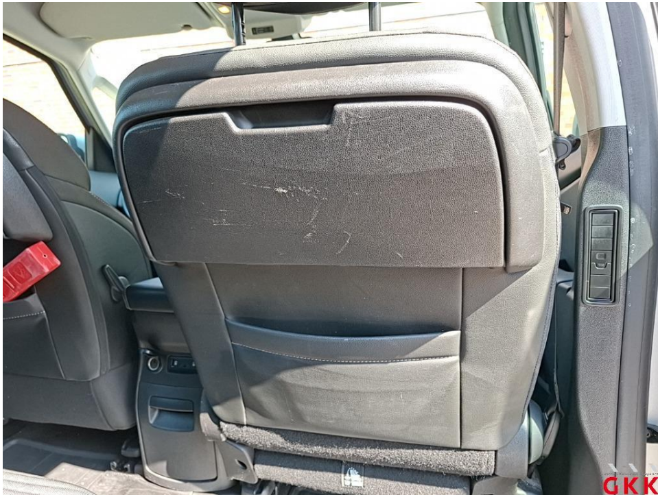
Bild 46. Sitz vorne rechts, Verkleidung, verkratzt, ersetzen
