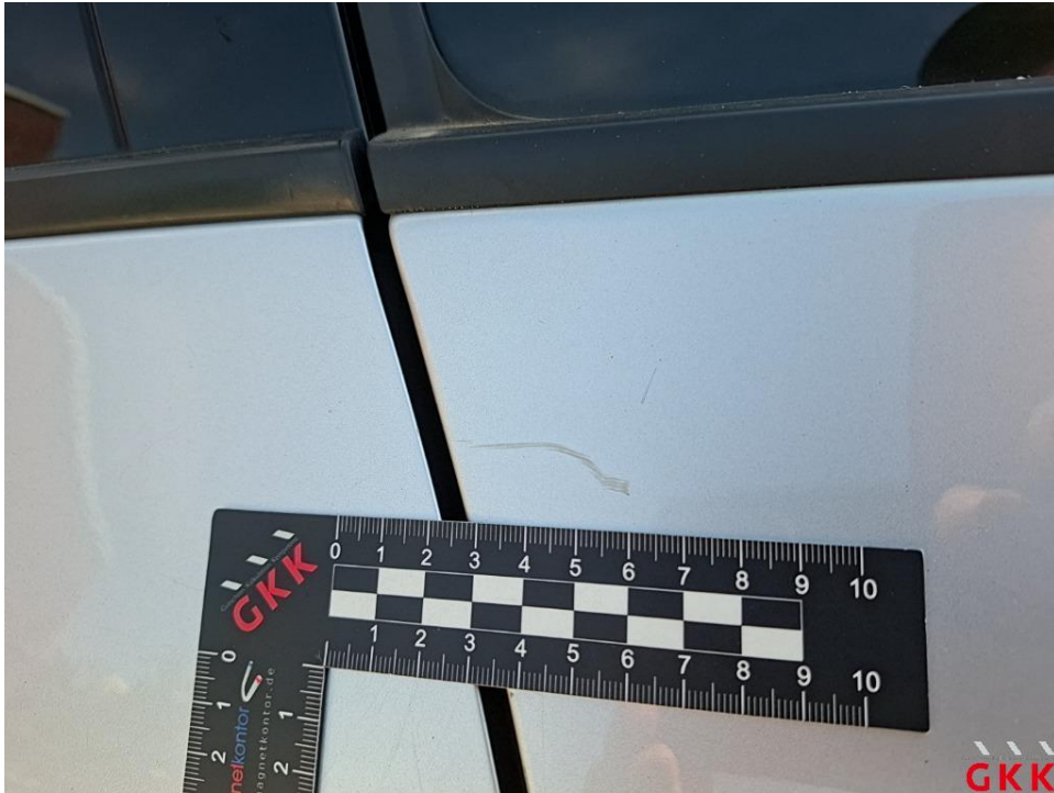
Bild 27. Seitenwand links, verkratzt, lackieren
