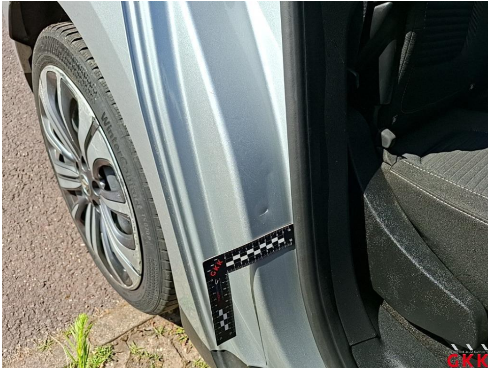
Bild 43. Tür hinten rechts, Einstieg, beschädigt, instand setzen - lackieren
