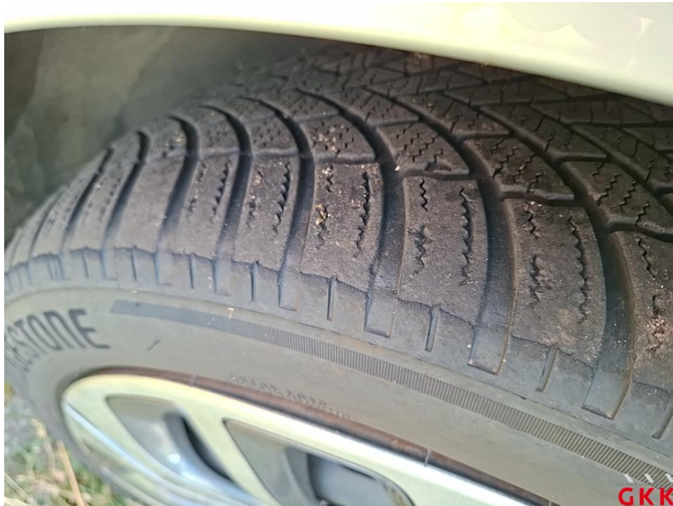
Bild 14. Reifen, vorn links und rechts, Untermaß, ersetzen
