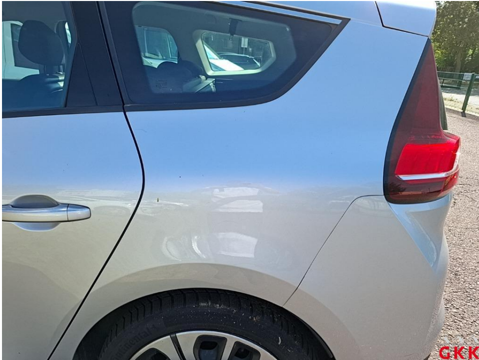
Bild 25. Seitenwand links, verkratzt, lackieren
