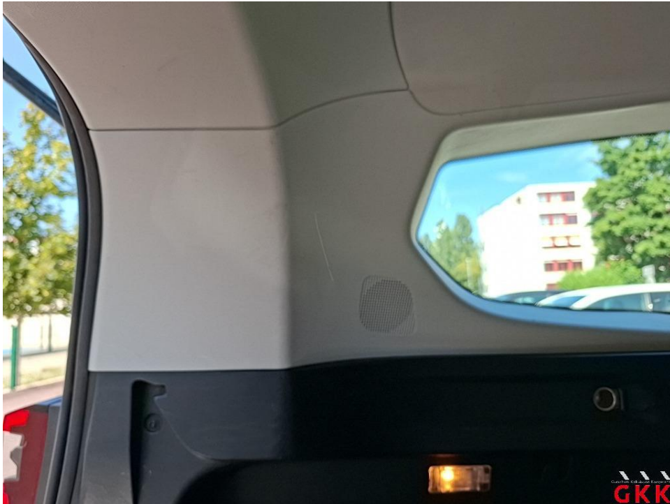
Bild 41. D- Säule links, Innenverkleidung, verkratzt, ersetzen
