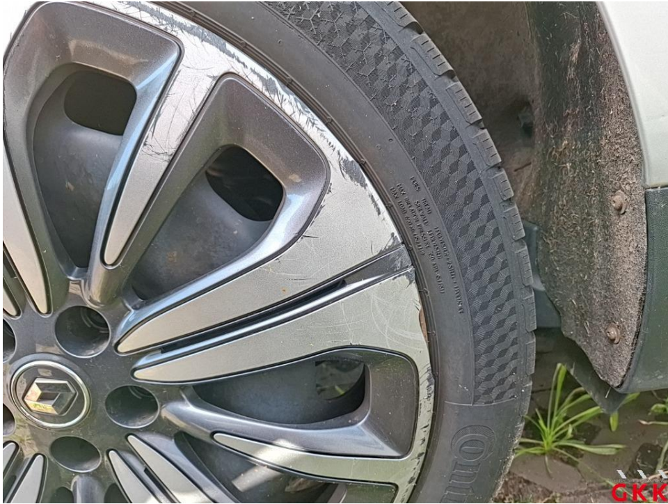
Bild 17. Radkappe(n), Satz, beschädigt, ersetzen
