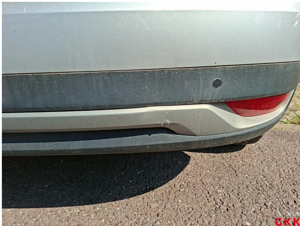
Bild 36. Stoßfänger hinten, Verkleidung unterhalb -unlackiert-, beschädigt, ersetzen
