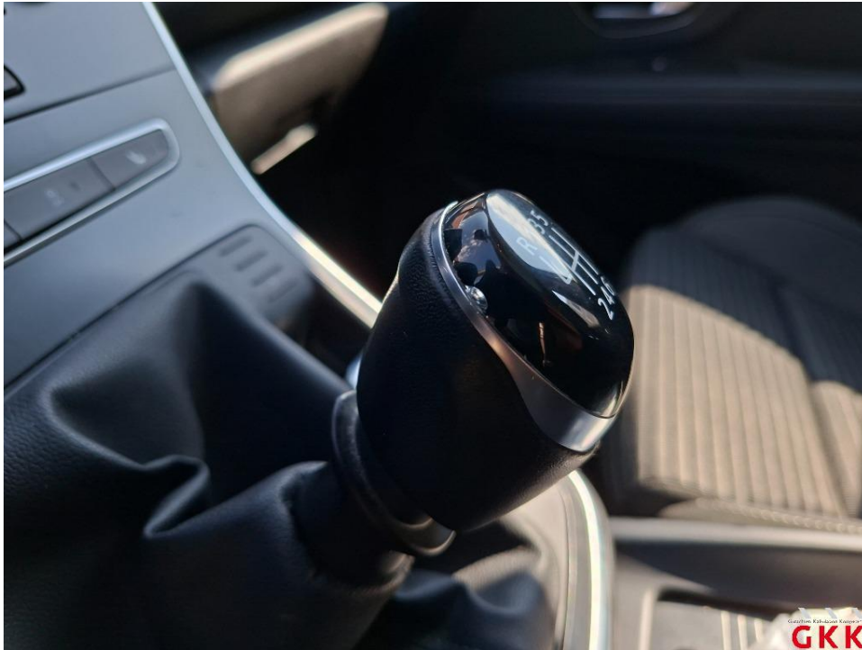
Bild 29. Schalthebel, Knauf -Standard-, beschädigt, ersetzen
