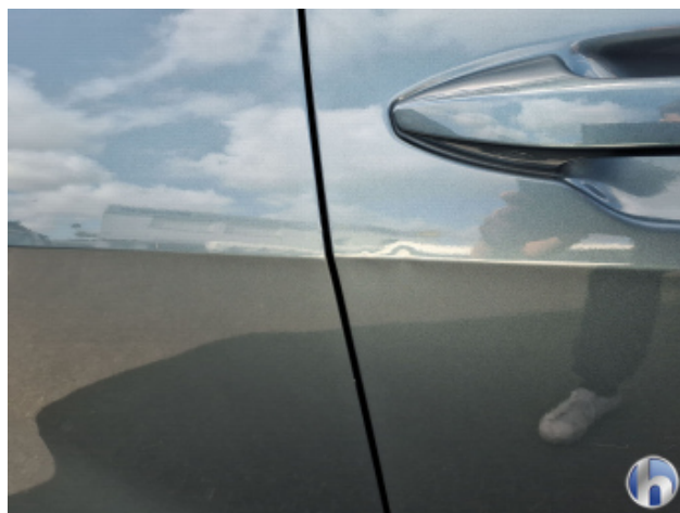
2. Tür Vorne - Rechts Verdellt - Sanft Instandsetzen
