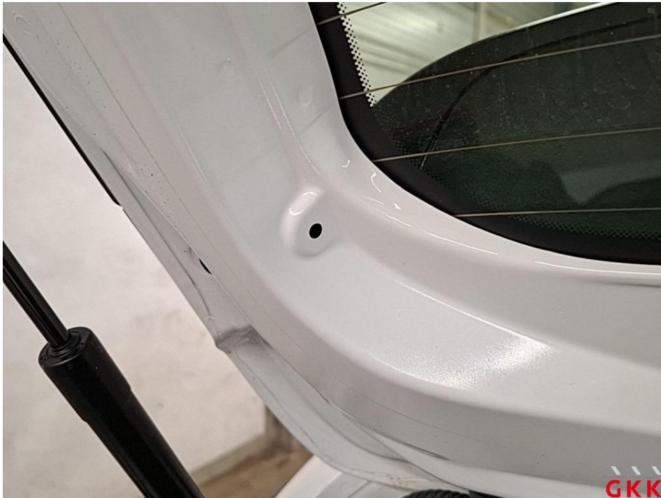
Bild 17 Laderaum, Abdeckung -Halteseil-, fehlt, ersetzen
