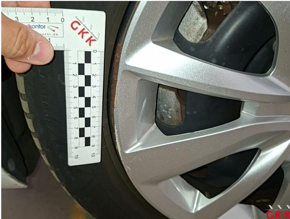
Bild 21 Radkappe(n), vorne links, beschädigt, ersetzen
