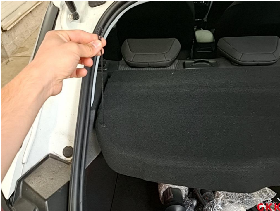
Bild 15 Laderaum, Abdeckung -Halteseil-, fehlt, ersetzen
