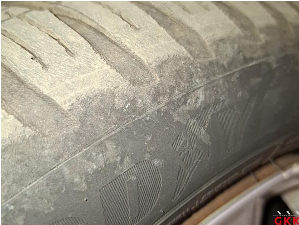
Bild 19 Reifen, vorn links und rechts, einseitig abgefahren und Untermaß, ersetzen
