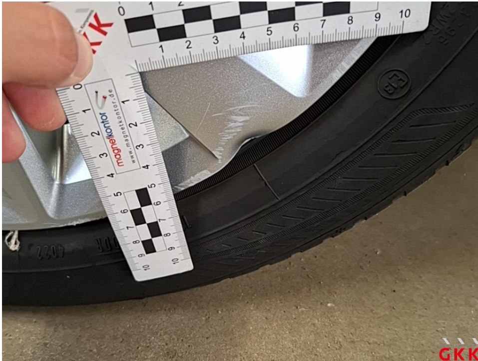
Bild 23 Radkappe(n), vorne rechts, beschädigt, ersetzen
