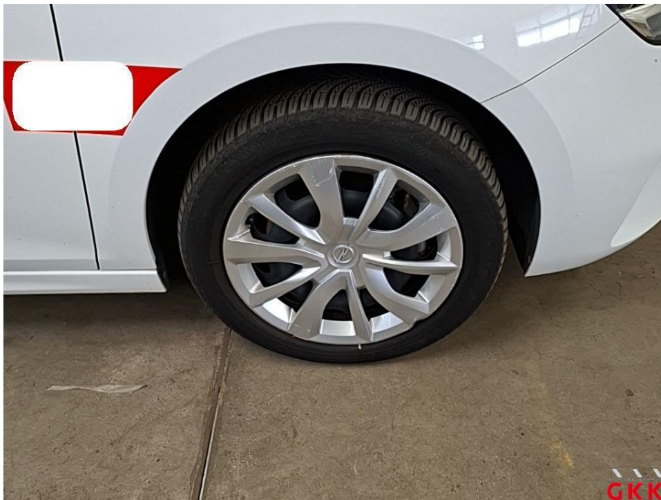
Bild 22 Radkappe(n), vorne rechts, beschädigt, ersetzen
