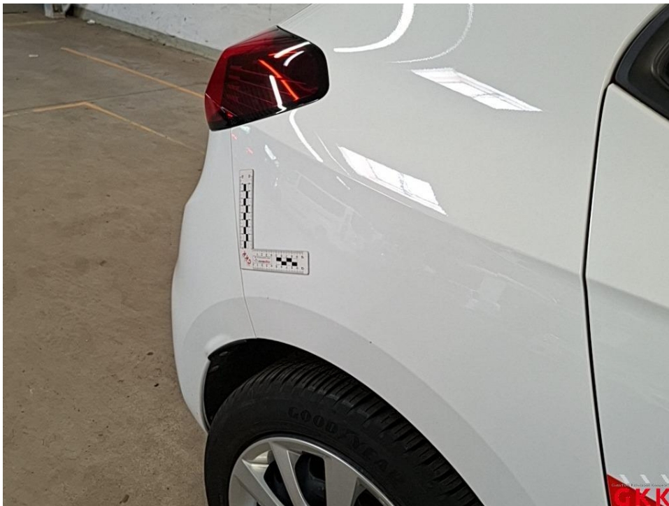
Bild 24 Seitenwand rechts, beschädigt, instand setzen - lackieren
