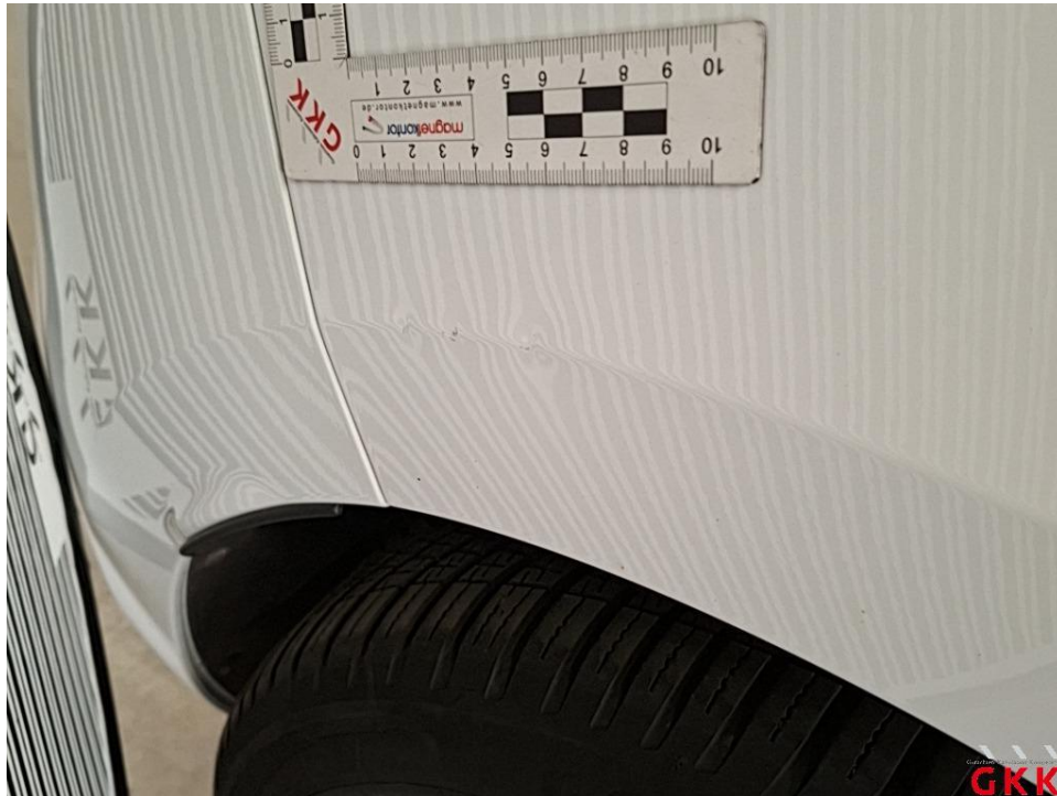
Bild 25 Seitenwand rechts, beschädigt, instand setzen - lackieren
