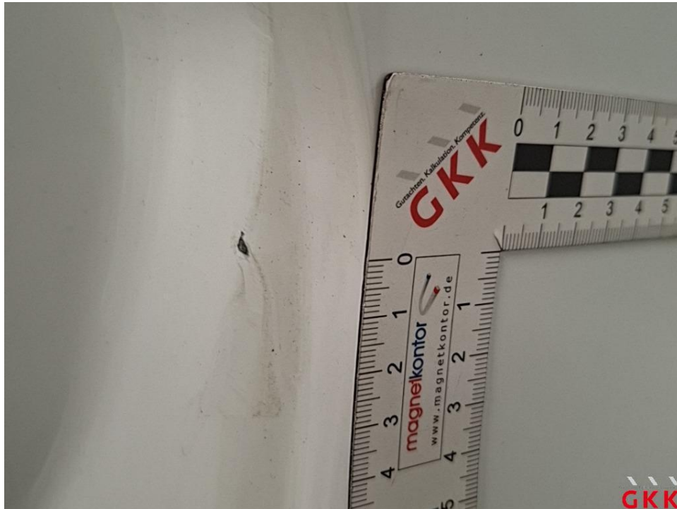
Bild 27 C- Säule links, verkratzt, Smartrepair
