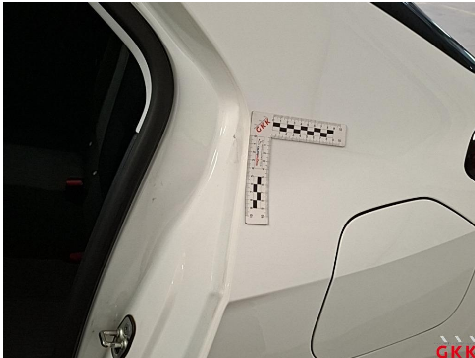
Bild 26 C- Säule links, verkratzt, Smartrepair
