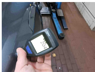
Lackstärke Seitenwand hinten rechts
