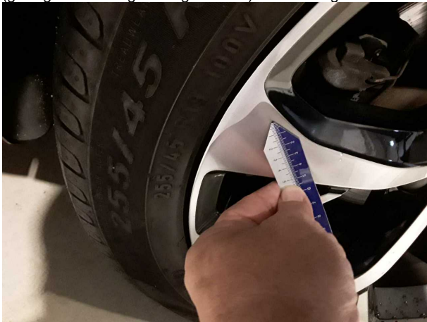
Beschädigung #6: Rad/Reifen: Leichtmetallfelge hinten links (glanzgedrehte Felge nachgearbeitet) - nicht fachgerecht
