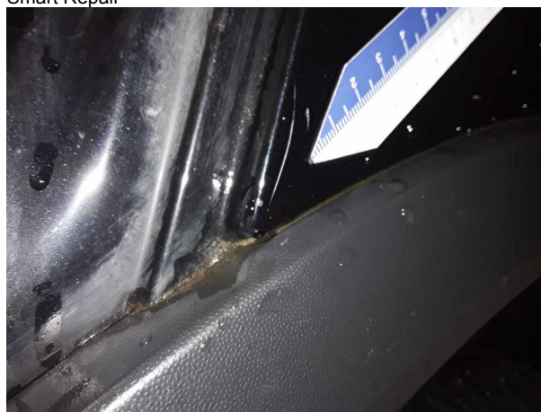
Beschädigung #4: Seitenwand links: Seitenwand - Kratzer - Smart Repair
