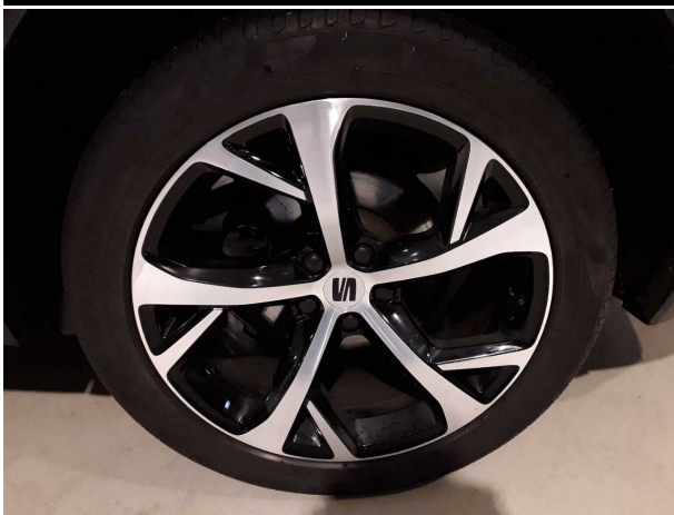
Beschädigung #6: Rad/Reifen: Leichtmetallfelge hinten links (glanzgedrehte Felge nachgearbeitet) - nicht fachgerecht
