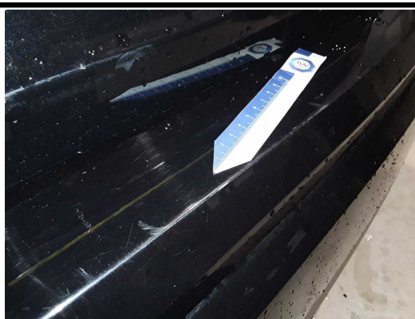
Beschädigung #5: Stossfänger hinten: Stossfänger hinten - verkratzt / verschürft - lackieren
