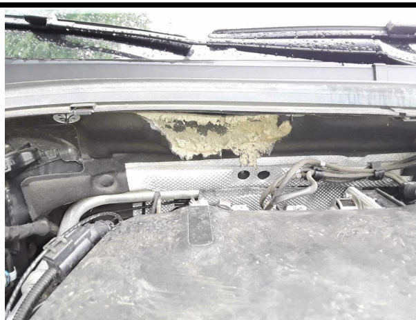
Beschädigung #3: Karosserie: Stirnwandverkleidung (Dämmmatte) - Marderschaden - erneuern
