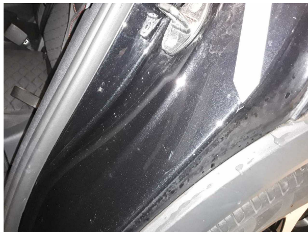
Beschädigung #1: Karosserie: C-Säule links unten - Kratzer - Smart Repair
