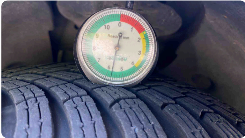
Photo mesure usure pneu avant gauche
