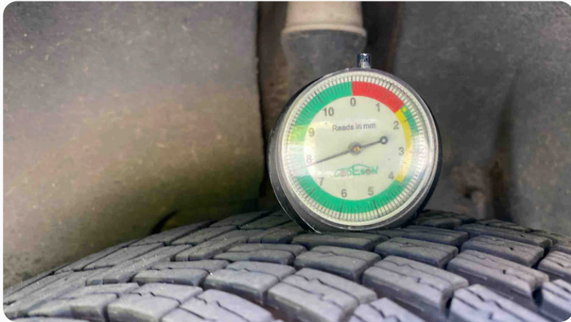
Photo mesure usure pneu arrière gauche
