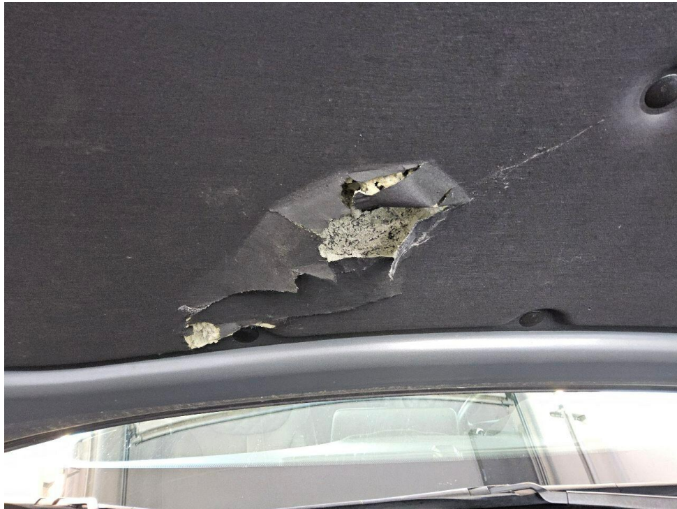
Bild 9 : Motorhaube, Dämmung beschädigt
