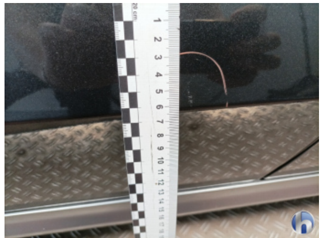
3. Tür Hinten - Rechts Kratzer - Lackieren
