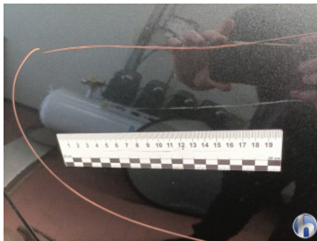
3. Tür Hinten - Rechts Kratzer - Lackieren
