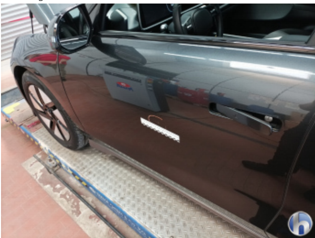
1. Tür Vorne - Links Beschädigt - Instandsetzen und Lackieren
