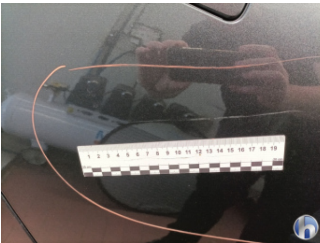
3. Tür Hinten - Rechts Kratzer - Lackieren
