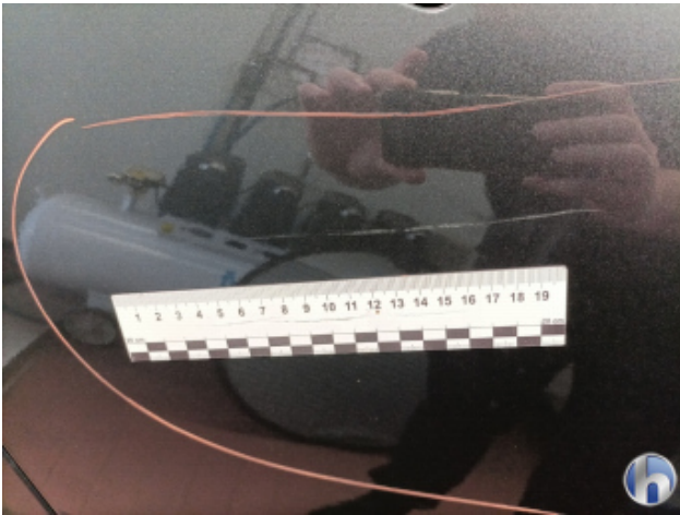
3. Tür Hinten - Rechts Kratzer - Lackieren
