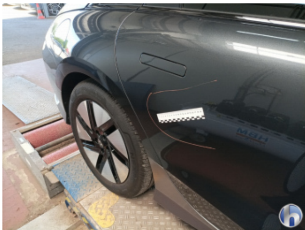
3. Tür Hinten - Rechts Kratzer - Lackieren
