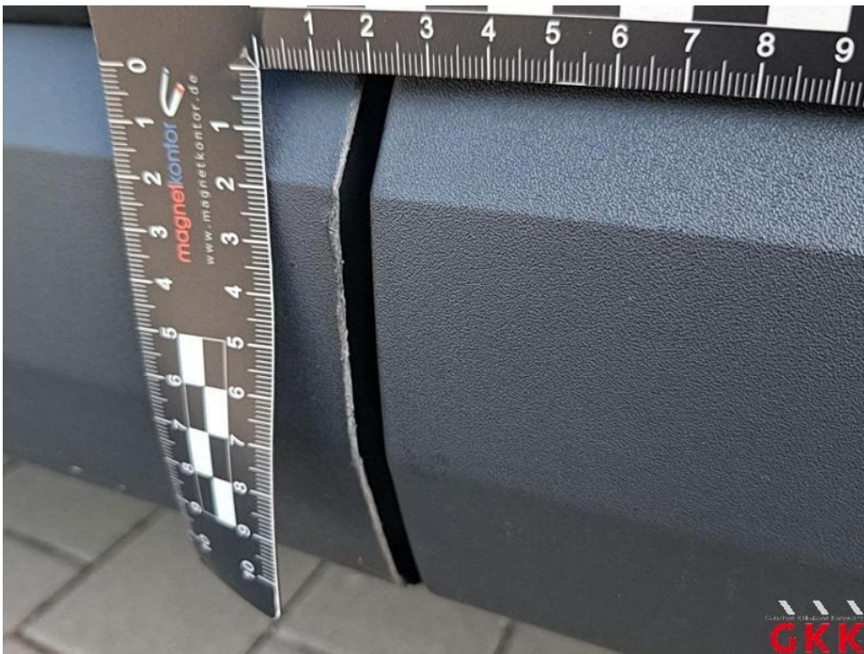
Bild 18. Tür vorne links, Leiste -unten-, beschädigt, ersetzen
