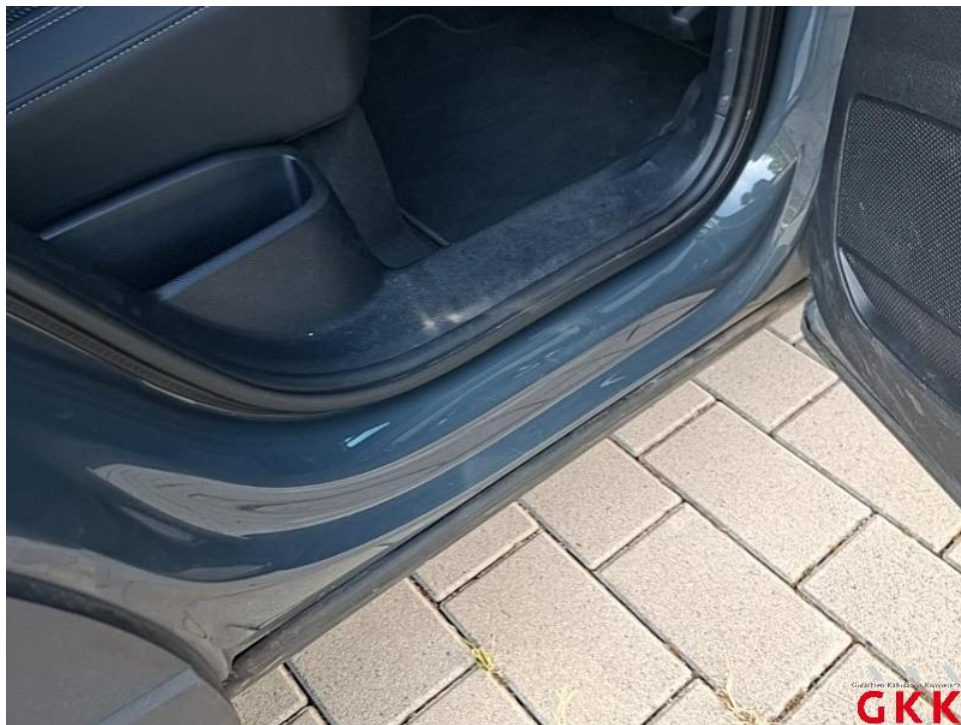
Bild 24. Tür hinten rechts, Einstieg, verkratzt, Smartrepair
