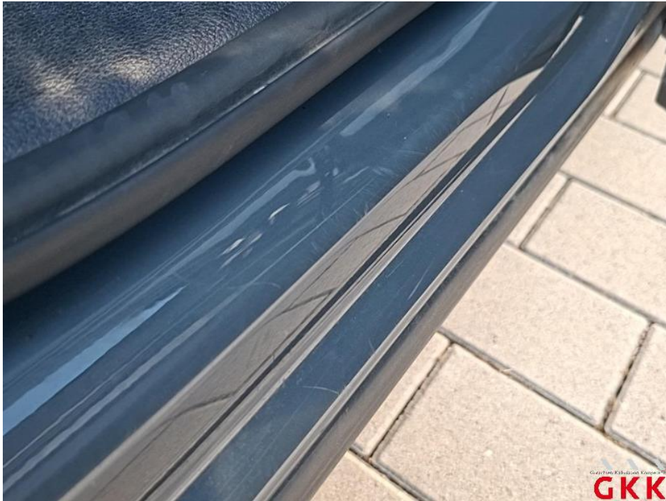
Bild 25. Tür hinten rechts, Einstieg, verkratzt, Smartrepair
