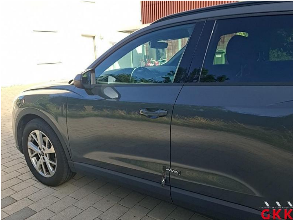
Bild 15. Tür vorne links, Kante, verkratzt, auslegen, schleifen, polieren
