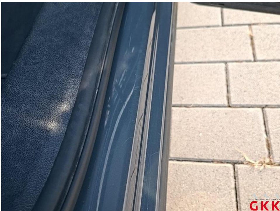
Bild 26. Tür hinten rechts, Einstieg, verkratzt, Smartrepair
