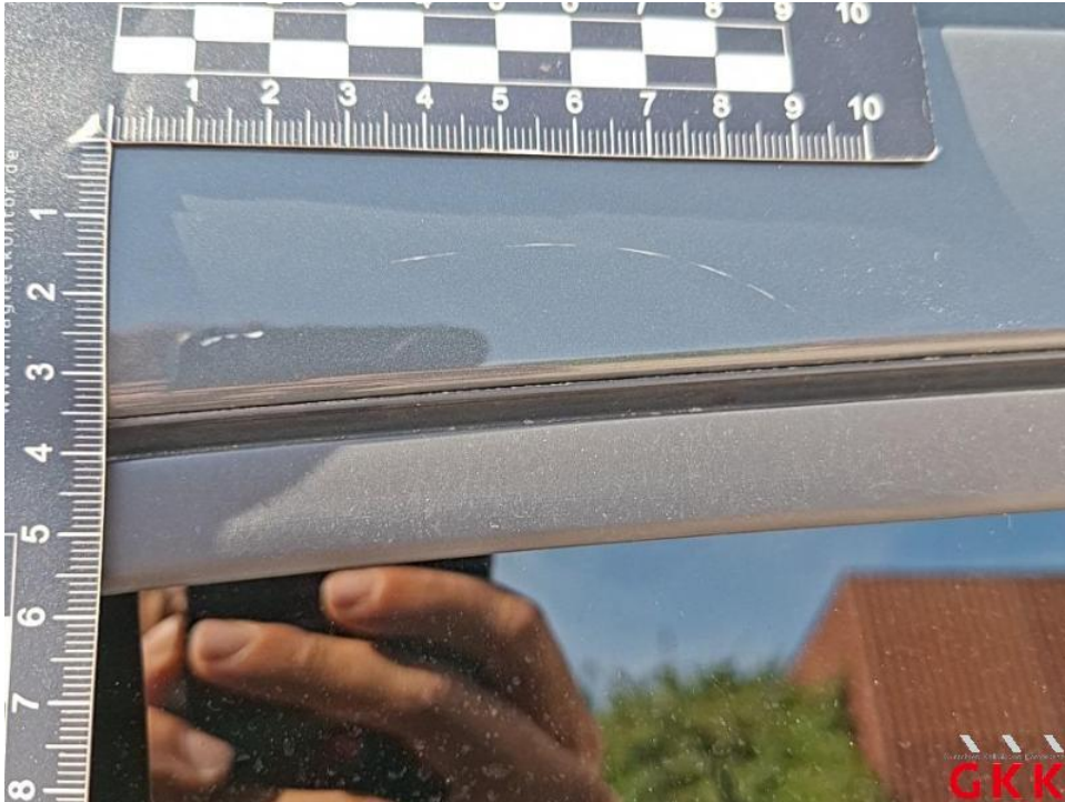
Bild 37. Dach, Holm rechts, verkratzt, lackieren
