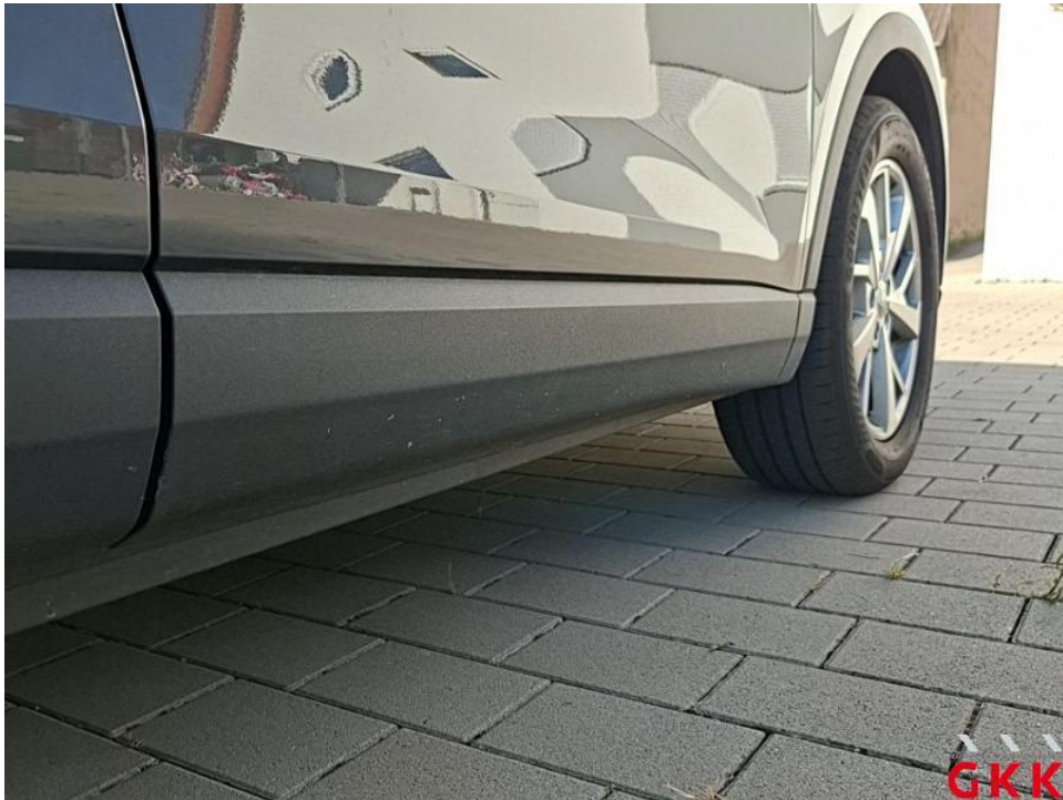
Bild 34. Tür vorne rechts, Leiste -unten-, beschädigt, ersetzen
