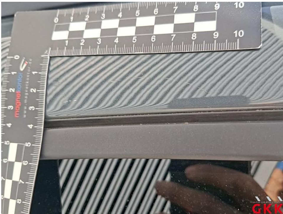
Bild 38. Dach, Holm rechts, verkratzt, lackieren
