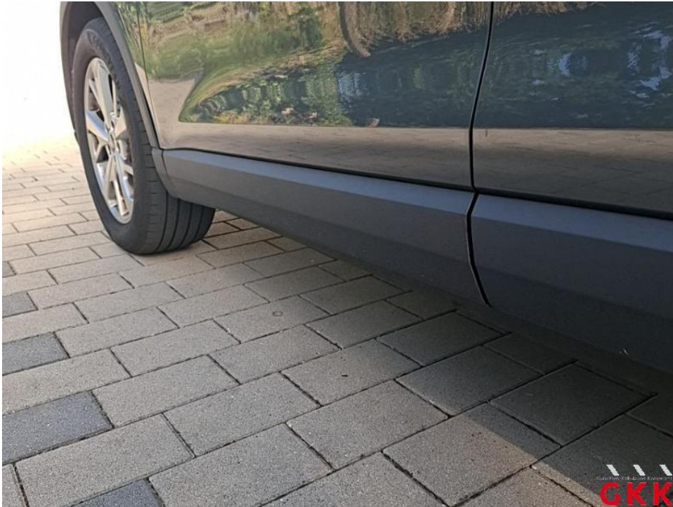
Bild 17. Tür vorne links, Leiste -unten-, beschädigt, ersetzen
