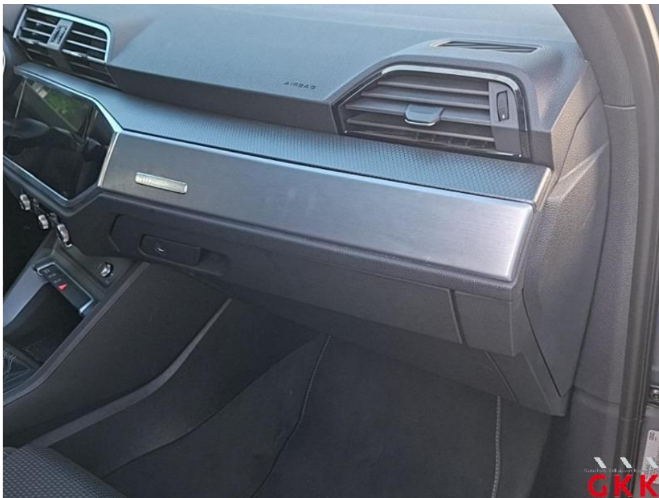
Bild 22. Armaturenbrett, Blende, verkratzt, ersetzen
