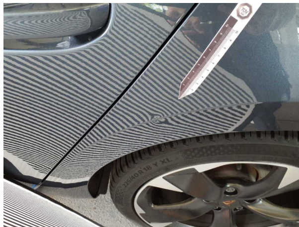
Beschädigung #1: Seitenwand links: Seitenwand - Delle(n) - sanft instandsetzen
