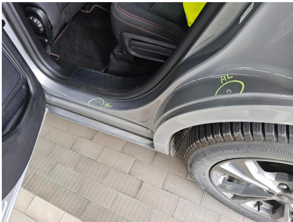
Bild 6 : Tür hinten links Einstieg, mehrfach eingedellt, drücken
