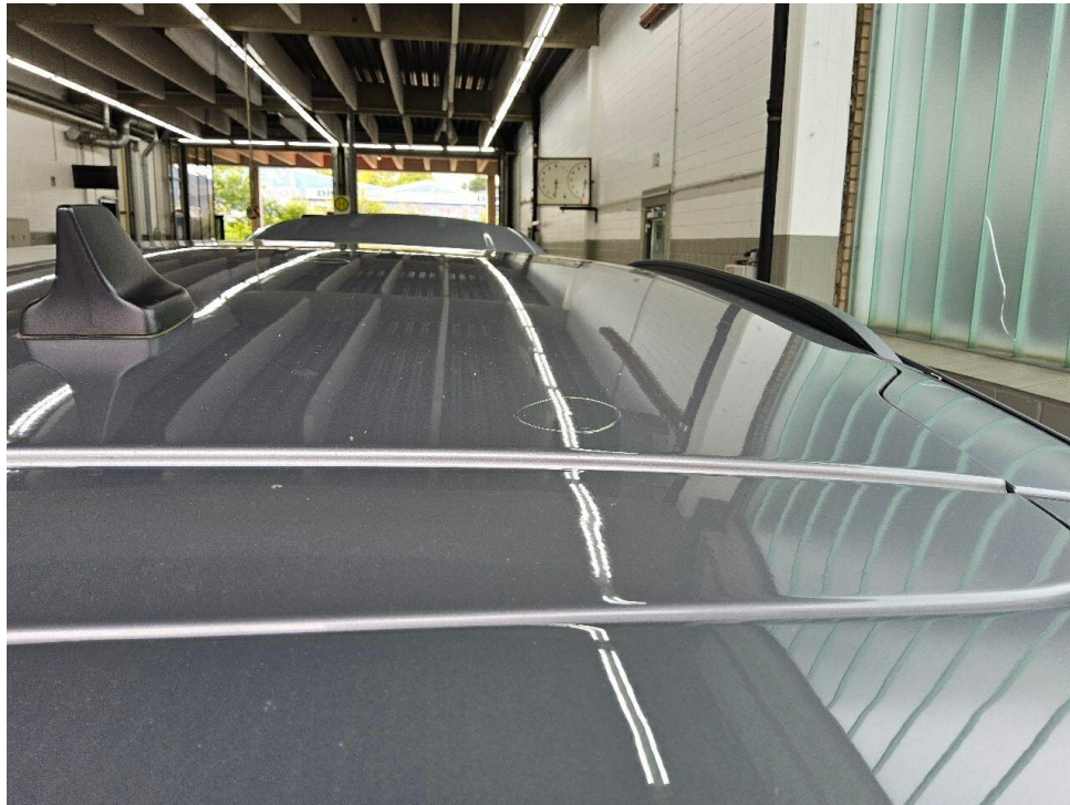
Bild 15 : Hagelschaden auf dem Dach, drücken
