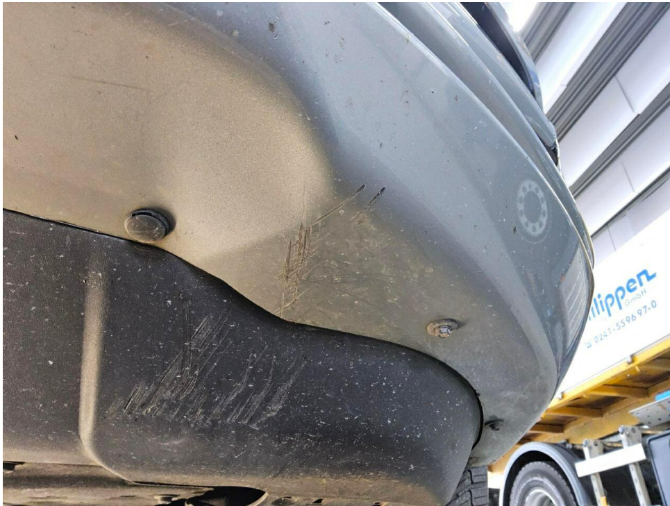
Bild 11 : Frontspoiler, deformiert, instandsetzen und lackieren mit Lackaufbau
