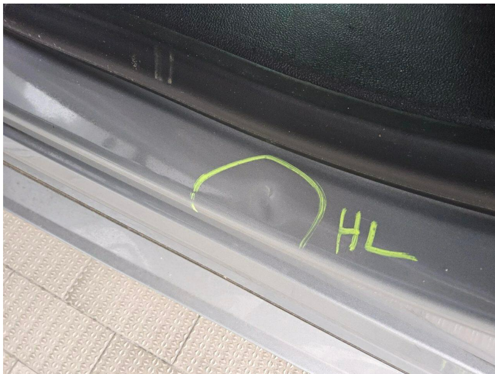
Bild 8 : Tür hinten links Einstieg, mehrfach eingedellt, drücken
