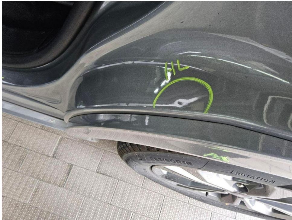
Bild 7 : Tür hinten links Einstieg, mehrfach eingedellt, drücken
