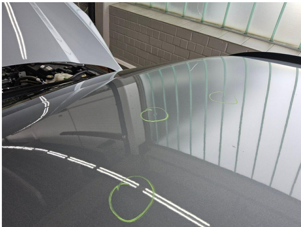
Bild 17 : Hagelschaden auf dem Dach, drücken
