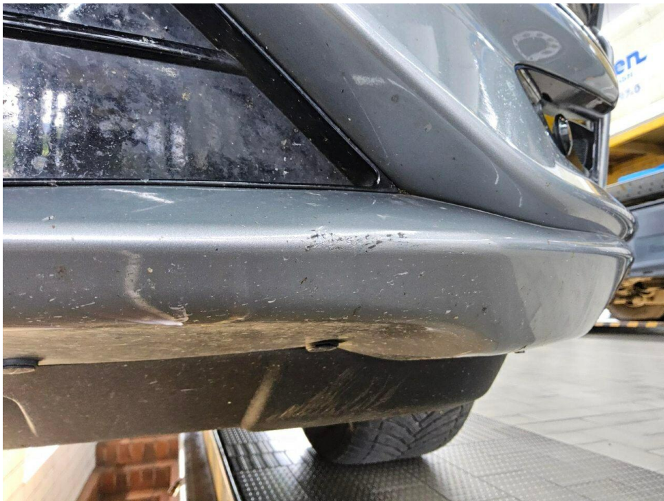
Bild 12 : Frontspoiler, deformiert, instandsetzen und lackieren mit Lackaufbau
