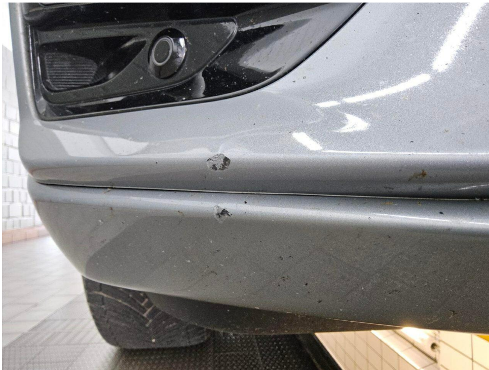
Bild 10 : Frontspoiler, deformiert, instandsetzen und lackieren mit Lackaufbau
