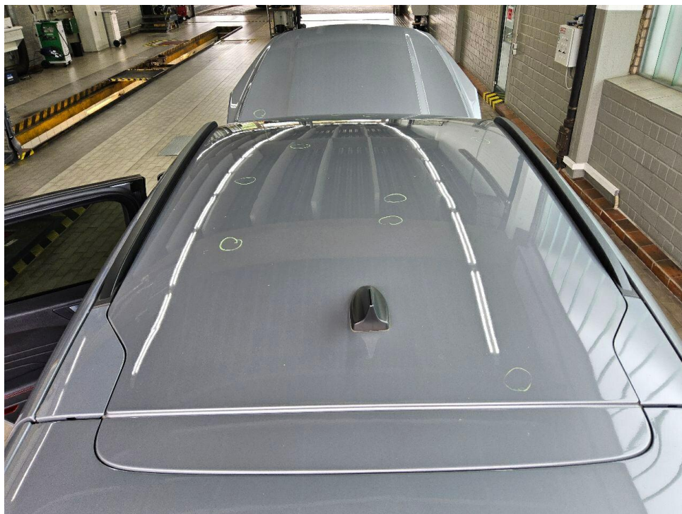
Bild 14 : Hagelschaden auf dem Dach, drücken
