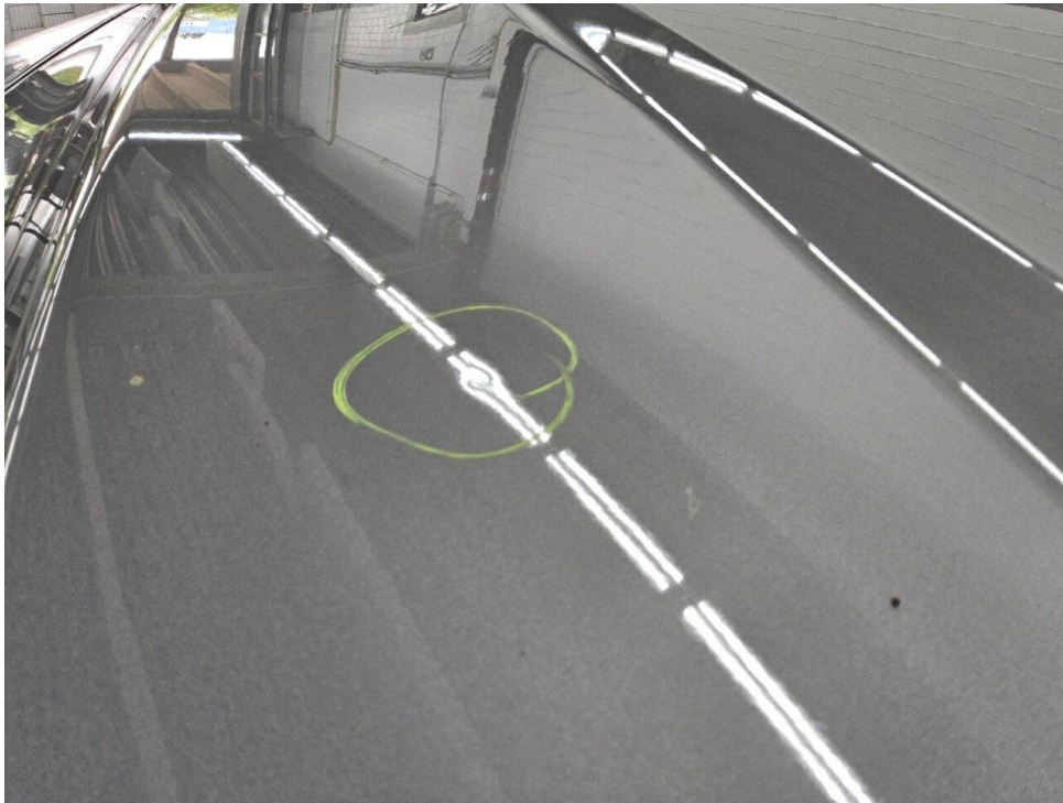
Bild 9 : Motorhaube, eingedellt, drücken
