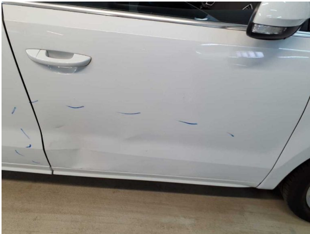
Beschädigung #15: Tür vorn rechts: Tür - verformt - erneuern
