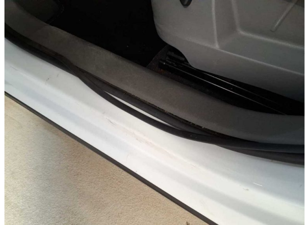
Beschädigung #3: Tür vorn links: Türdichtung - beschädigt - erneuern
