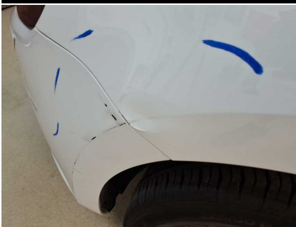
Beschädigung #14: Kotflügel links: Kotflügel links - Delle / Lackschaden - erneuern
