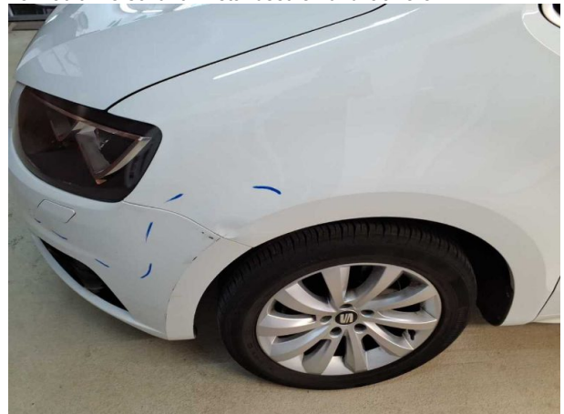
Beschädigung #14: Kotflügel links: Kotflügel links - Delle / Lackschaden - erneuern
