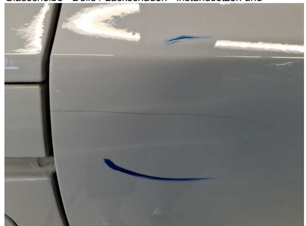
Beschädigung #11: Schiebetür rechts: Schiebetür mit Glasscheibe - Delle / Lackschaden - instandsetzen und
