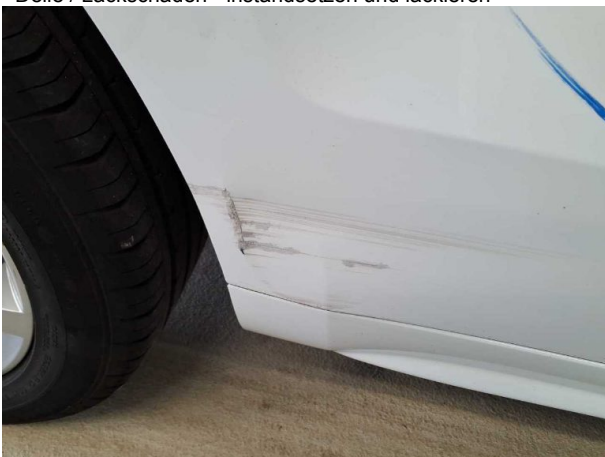
Beschädigung #11: Schiebetür rechts: Schiebetür mit Glasschei... - Delle / Lackschaden - instandsetzen und lackieren
