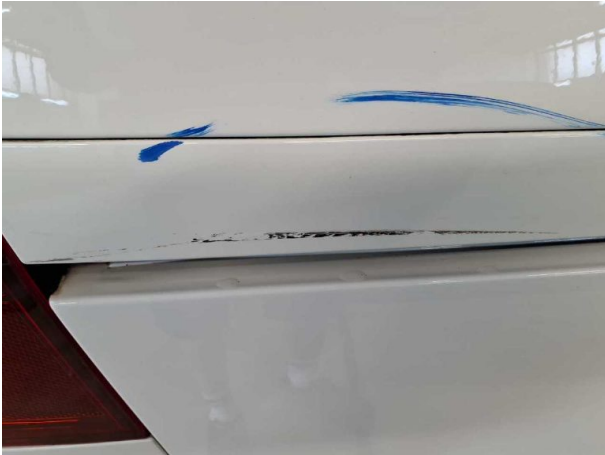
Beschädigung #13: Seitenwand rechts: Seitenwand - verkratzt / verschürft - instandsetzen und lackieren
