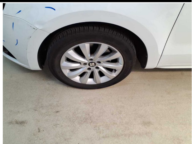
Beschädigung #7: Rad/Reifen: Leichtmetallfelge vorn links - verkratzt / verschürft - Wertminderung
