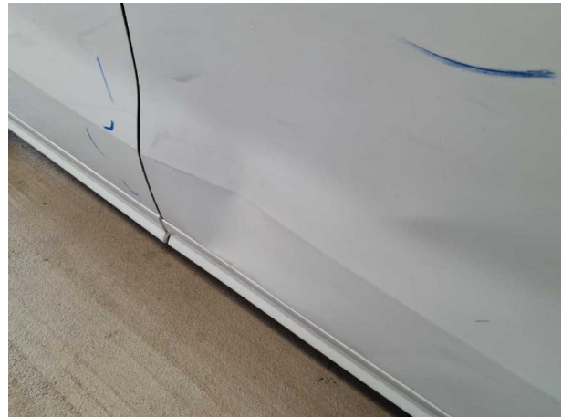
Beschädigung #15: Tür vorn rechts: Tür - verformt - erneuern
