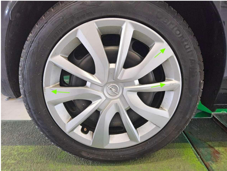
Bild 15 : Felge hinten rechts Radzierdeckel, verschrammt, erneuern
