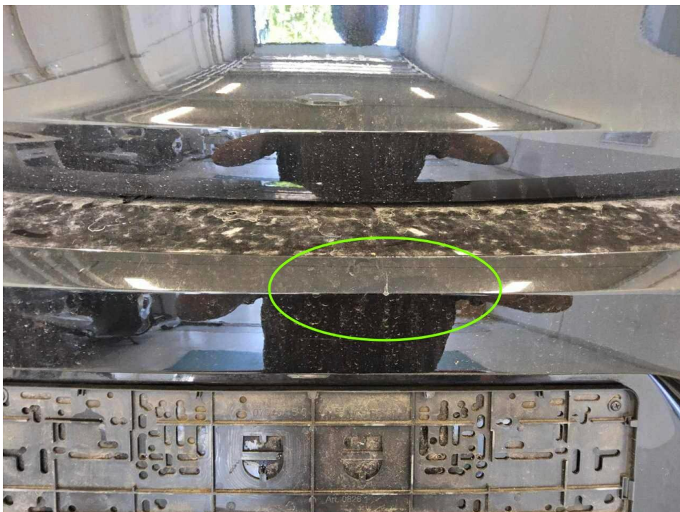
Bild 22 : Stoßfänger hinten Lackierung, verschrammt, lackieren mit Lackaufbau
