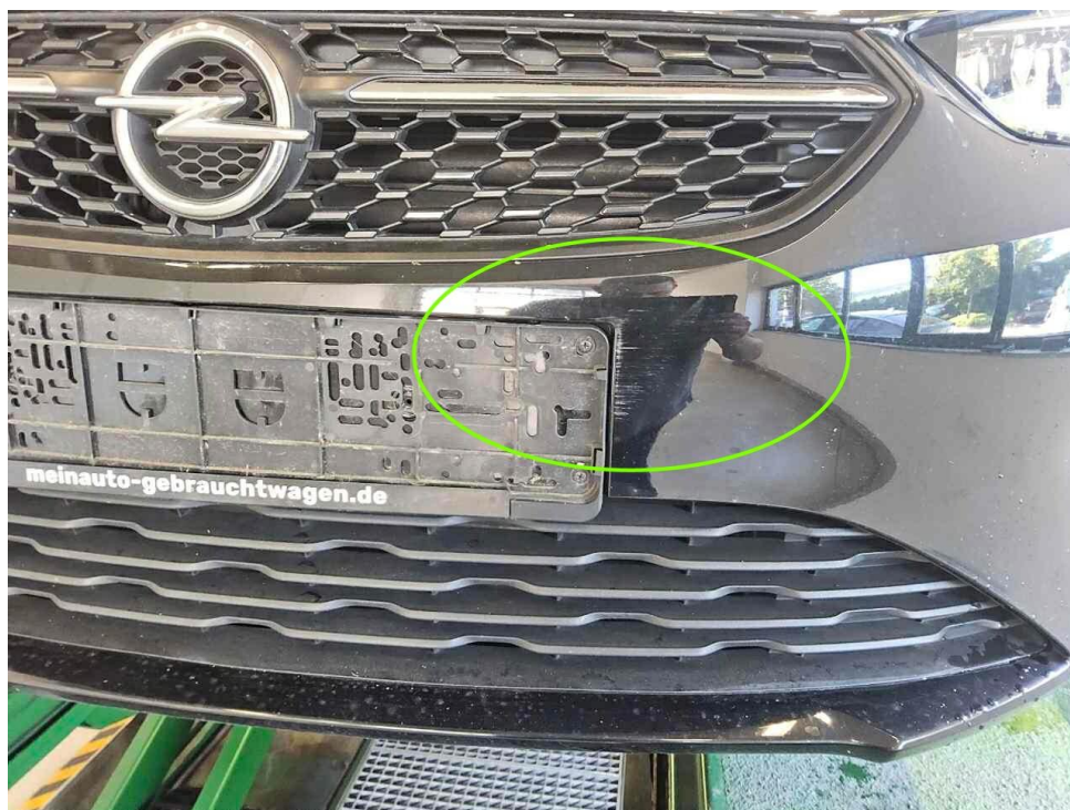
Bild 25 : Stoßfänger vorne Lackierung, verschrammt, lackieren mit Lackaufbau
