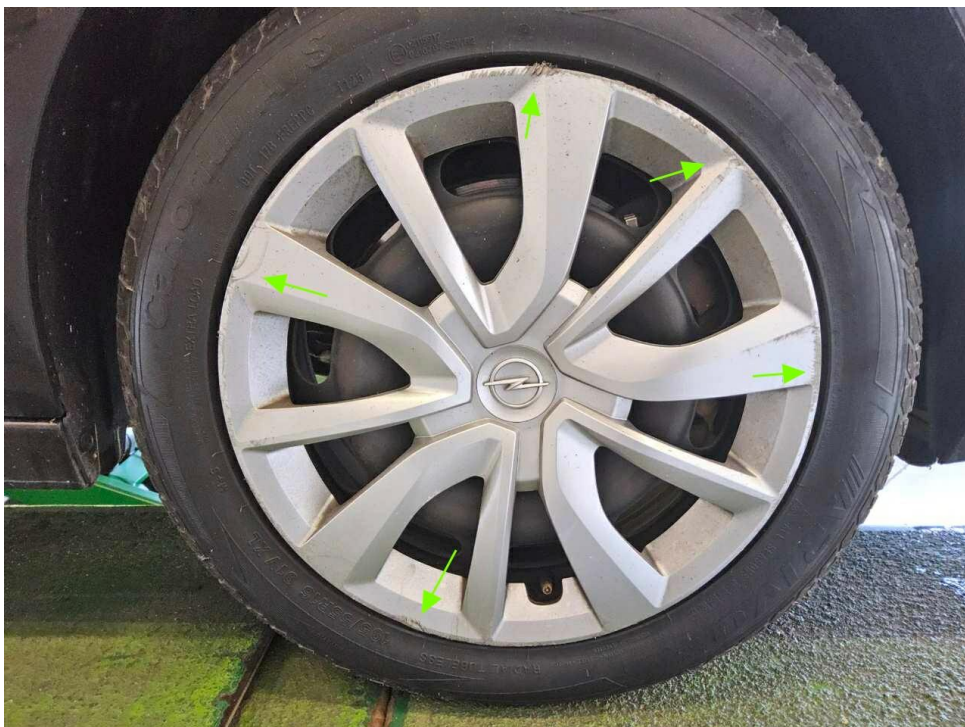
Bild 16 : Felge vorne rechts Radzierdeckel, verschrammt, erneuern
