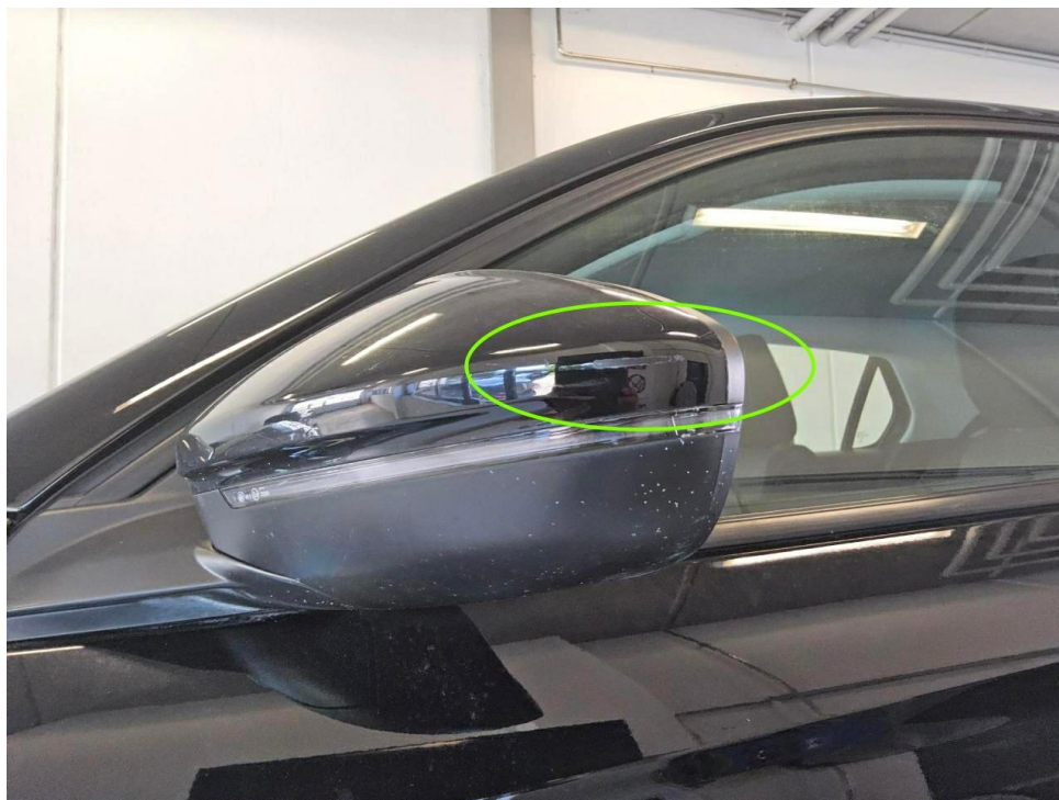
Bild 17 : Außenspiegel links Lackierung, zerkratzt, lackieren
