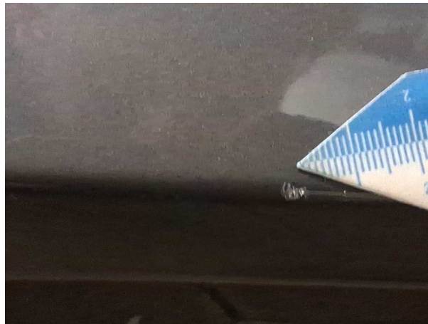
Beschädigung #1: Tür hinten rechts: Zierleiste unten - Kratzer - Smart Repair
