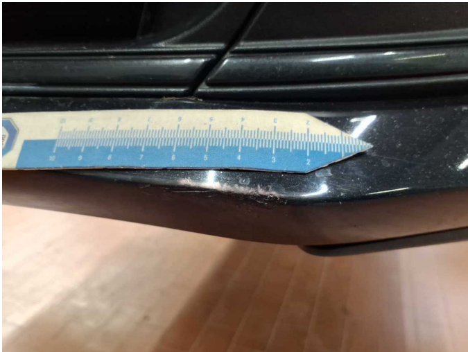
Damage 11: Front bumper: Front bumper (+ Verätzung) - Scratch(es) - Paint
