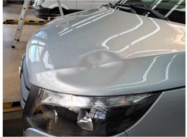
Beschädigung #6: Motorhaube: Motorhaube - verformt - erneuern
