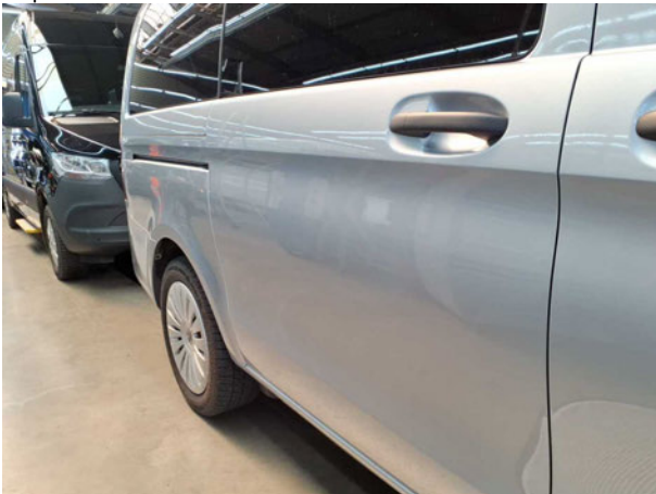
Beschädigung #2: Schiebetür rechts: Schiebetür mit Glasscheibe - Delle / Lackschaden - Smart Repair
