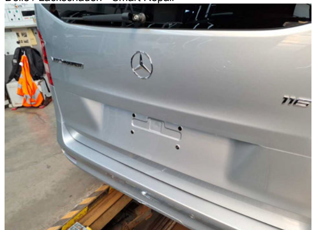
Beschädigung #3: Heckklappe/-tür: Heckklappe - Delle / Lackschaden - Smart Repair
