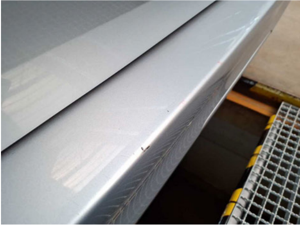
Beschädigung #5: Stossfänger hinten: Stossfänger hinten - Kratzer - lackieren
