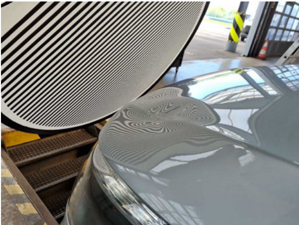
Beschädigung #6: Motorhaube: Motorhaube - verformt - erneuern
