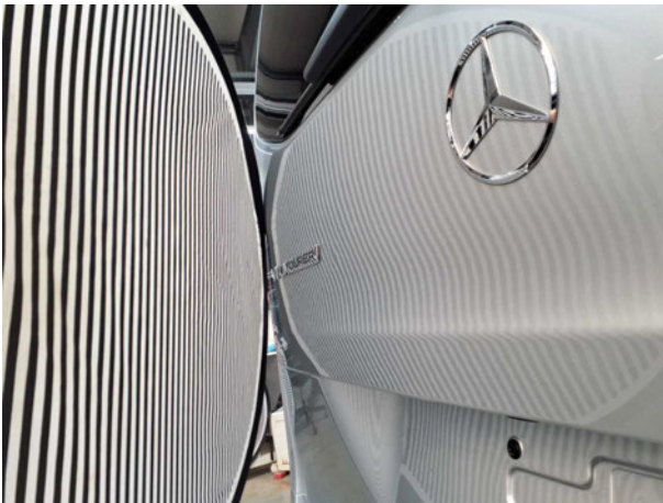
Beschädigung #3: Heckklappe/-tür: Heckklappe - Delle / Lackschaden - Smart Repair
