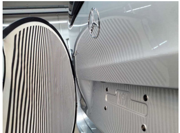
Beschädigung #3: Heckklappe/-tür: Heckklappe - Delle / Lackschaden - Smart Repair
