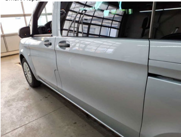
Beschädigung #4: Schiebetür links: Schiebetür mit Glasscheibe - Delle(n) - Smart Repair
