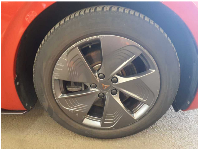
Damage 4: Wheel / tyres: Alloy rim - front right side (Mit Materialabtrag, Großflächig verkratzt) - Scratched - Replace
