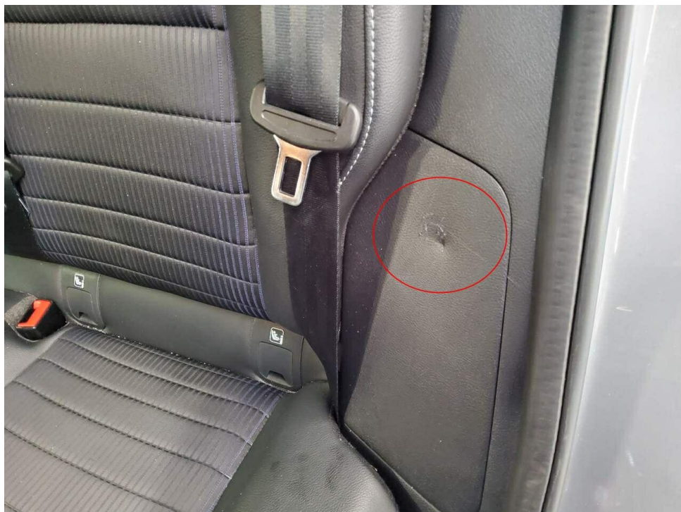
Bild 22 : Verkleidung C-Säule links unten, eingedellt, verschrammt
