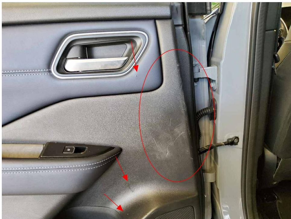
Bild 24 : Türverkleidung hinten links, verschrammt
