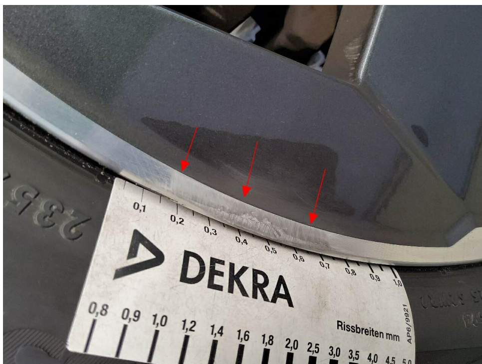
Bild 32 : LM-Felge hinten rechts, glanzgedreht, verschrammt
