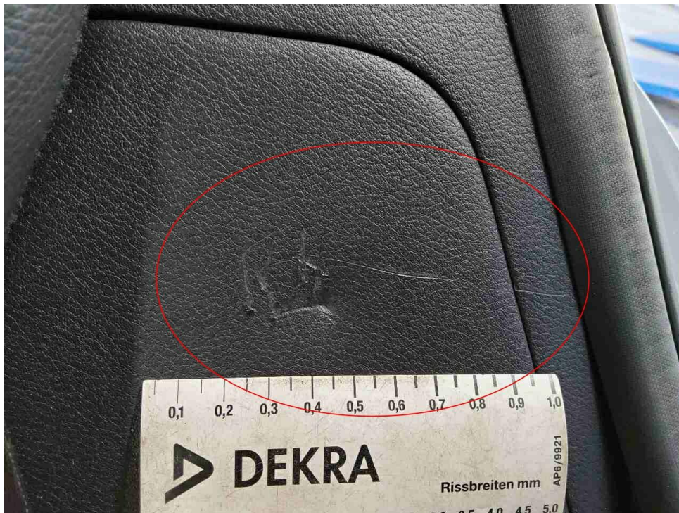
Bild 23 : Verkleidung C-Säule links unten, eingedellt, verschrammt
