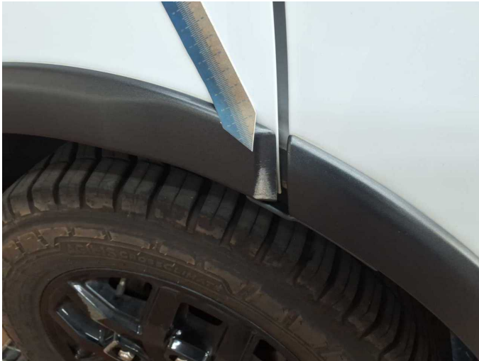
Damage 12: Mudguard - left side: Wheel well extension (Mit Verformung) - Scratch(es) - Replace
