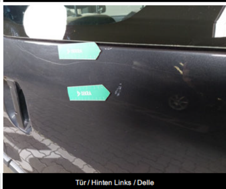
Tür / Hinten Links / Delle
