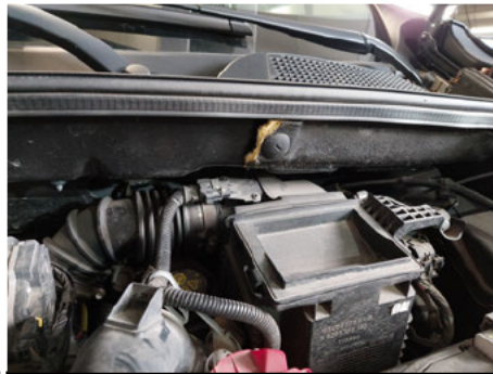
Dämmung Motorhaube / - / Defekt
