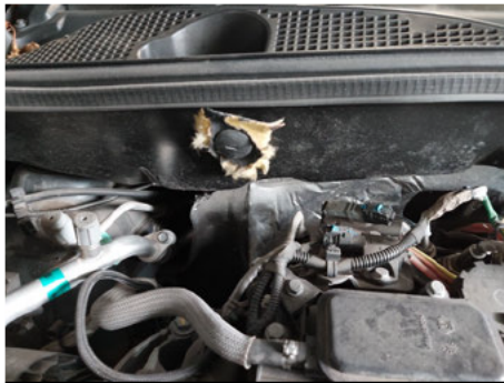
Dämmung Motorhaube / - / Defekt
