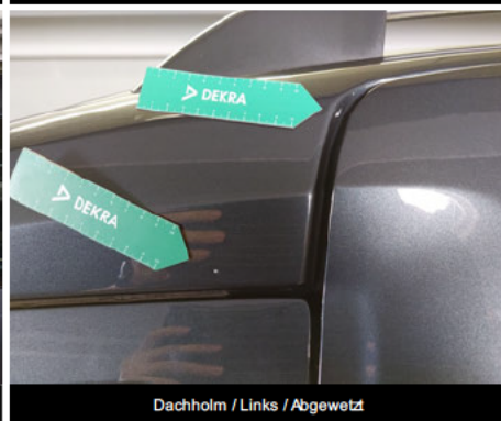
Dachholm / Links / Abgewetzt
