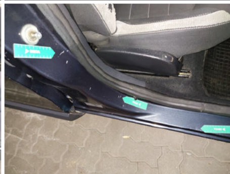
Türeinstieg / Vorne Rechts / Kratzer
