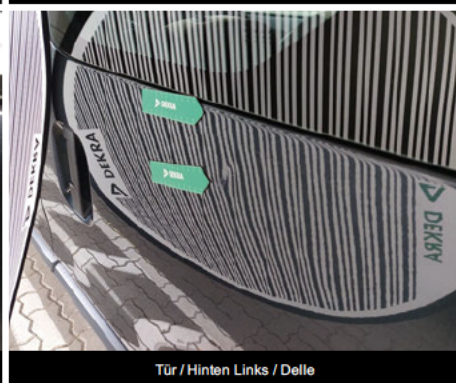
Tür / Hinten Links / Delle
