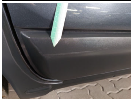
Tür / Hinten Rechts / Kratzer
