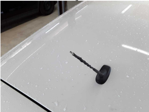
Beschädigung #2: Fahrzeugdach: Antennenstab - Marderschaden - erneuern
