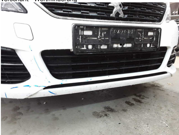
Beschädigung #7: Stossfänger vorn: Grill - lose - befunden ggf. instandsetzen
