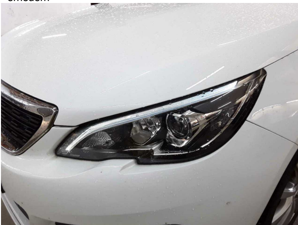
Beschädigung #3: Scheinwerfer: Scheinwerfer links (Ablendlicht) - ohne Funktion - erneuern
