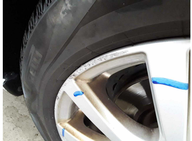
Beschädigung #1: Rad/Reifen: Leichtmetallfelge vorn rechts - verkratzt / verschürft - kein Abzug
