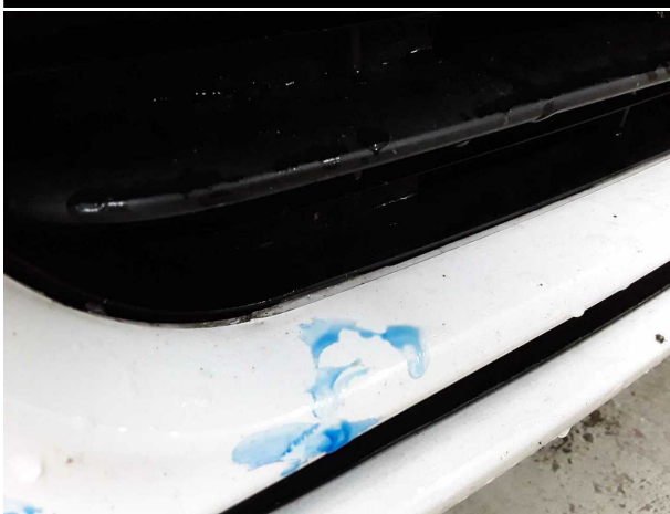
Beschädigung #7: Stossfänger vorn: Grill - lose - befunden ggf. instandsetzen
