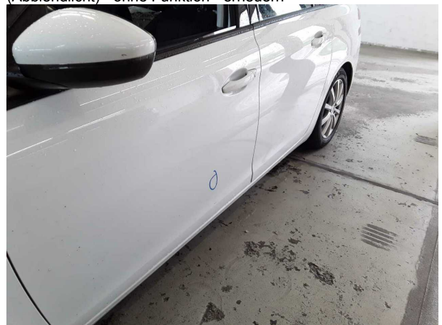
Beschädigung #5: Tür vorn links: Tür - Delle(n) - sanft instandsetzen
