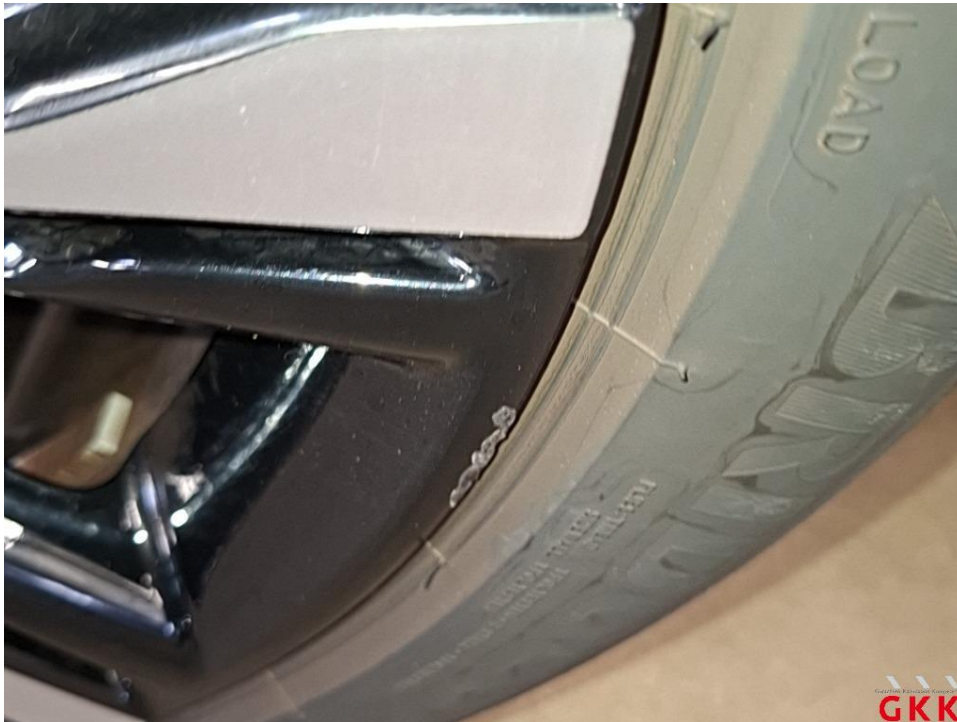
Bild 21 LM-Rad, vorne rechts, verkratzt, Smartrepair
