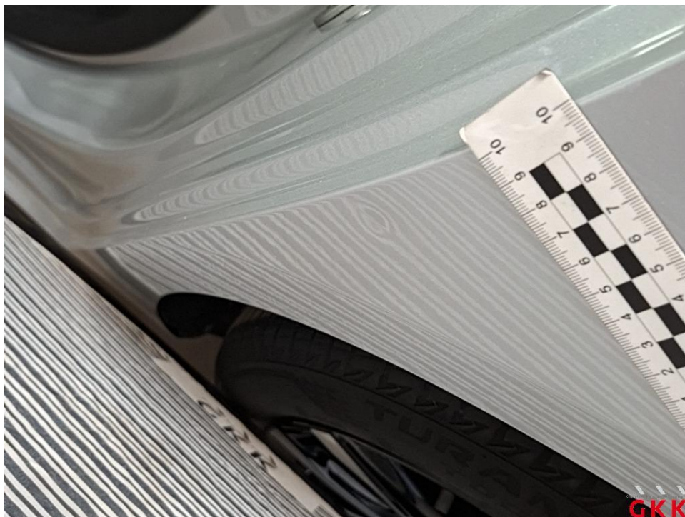
Bild 17 Seitenwand links, beschädigt, kalt drücken
