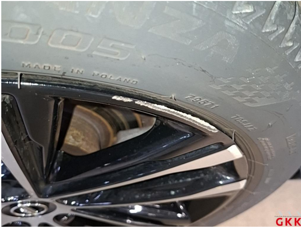
Bild 25 LM-Rad, hinten rechts, Materialabtrag, ersetzen
