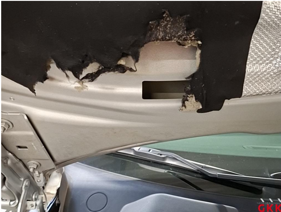
Bild 19 Motorhaube, Dämmmatte, beschädigt, ersetzen
