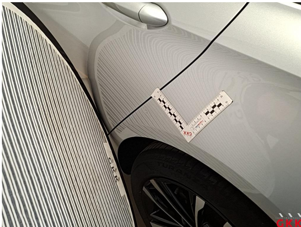
Bild 15 Seitenwand links, beschädigt, kalt drücken
