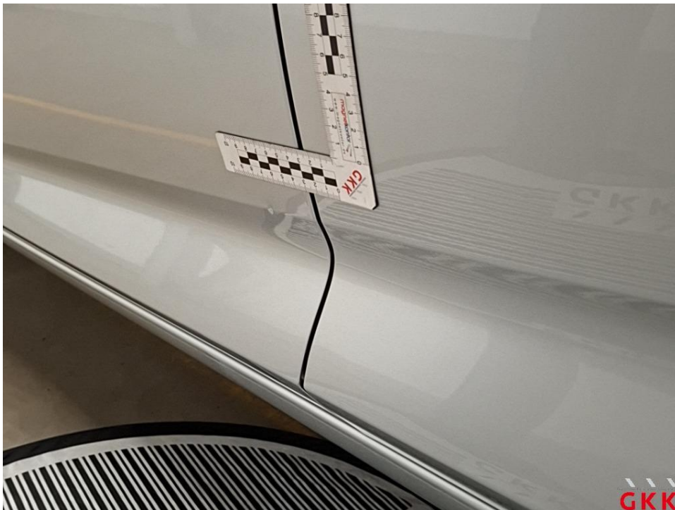
Bild 22 Tür vorne links, beschädigt, kalt drücken
