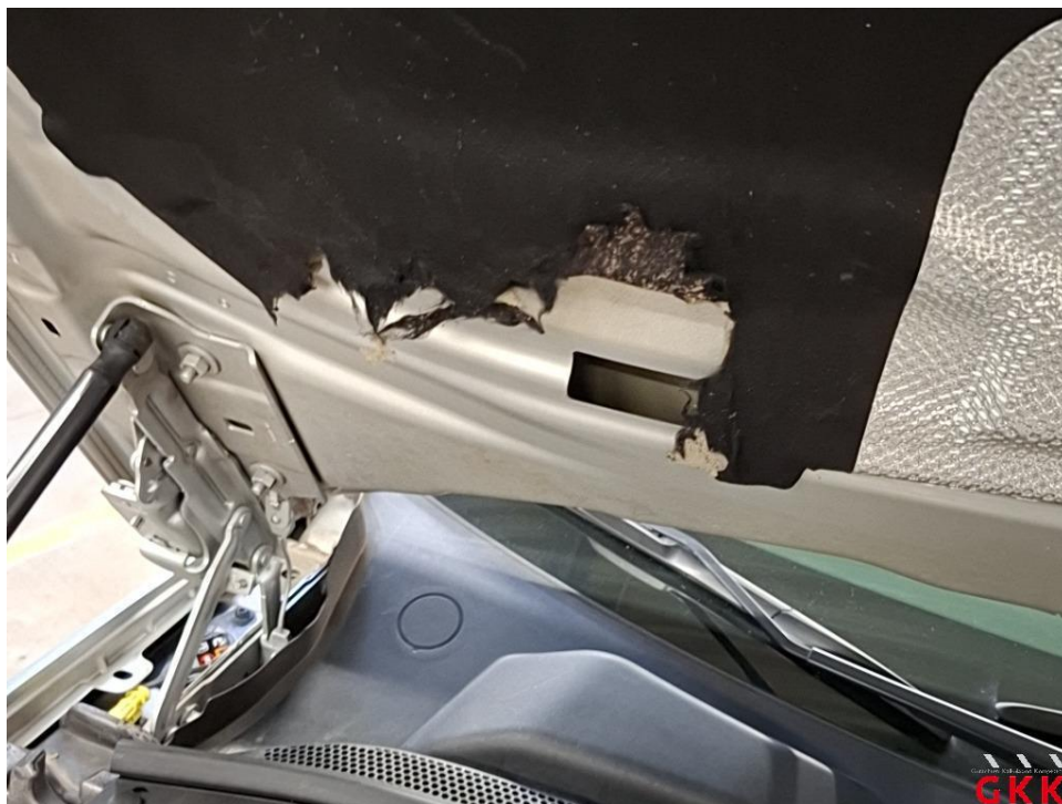
Bild 18 Motorhaube, Dämmmatte, beschädigt, ersetzen
