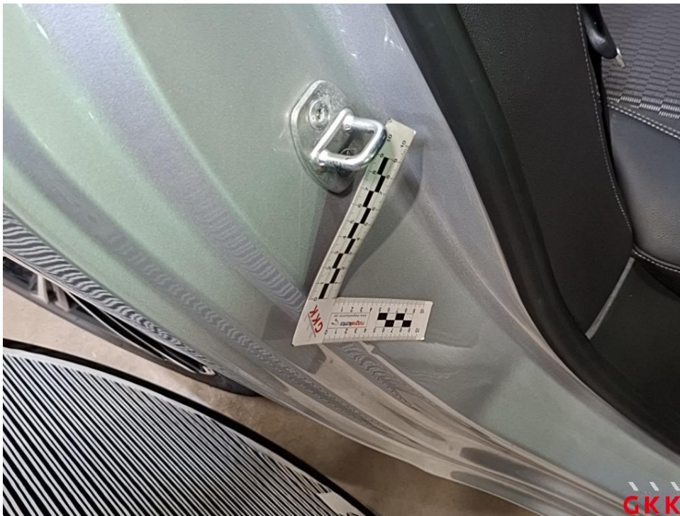
Bild 26 Tür hinten rechts, Einstieg, beschädigt, Smartrepair
