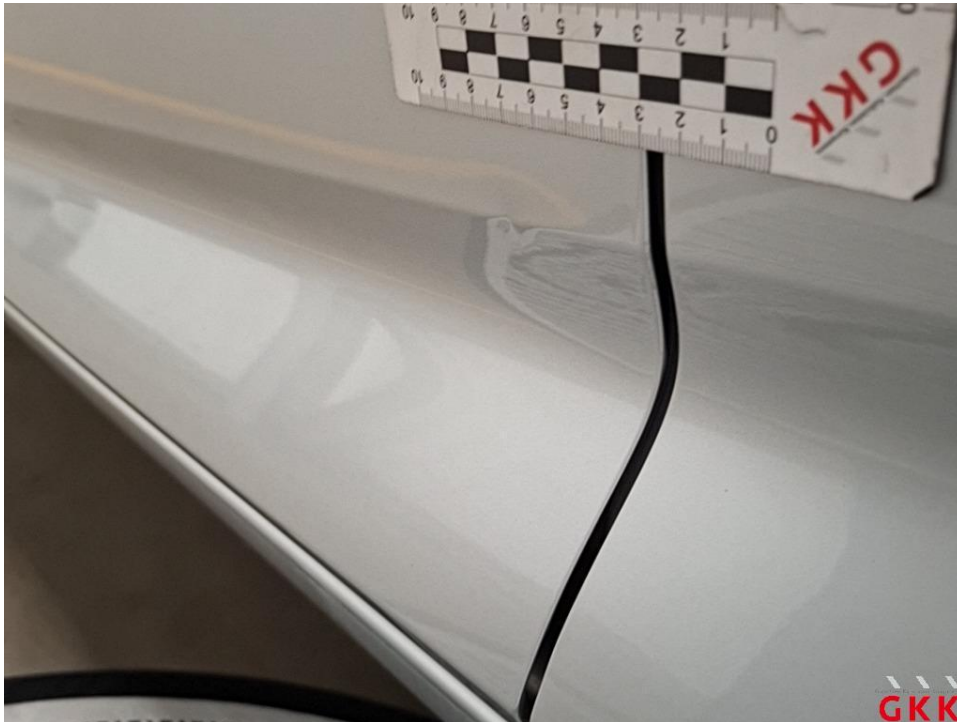
Bild 23 Tür vorne links, beschädigt, kalt drücken
