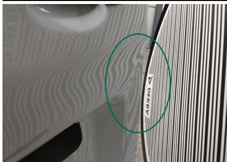
Heckklappe / Kofferraumtür / Links / Delle
