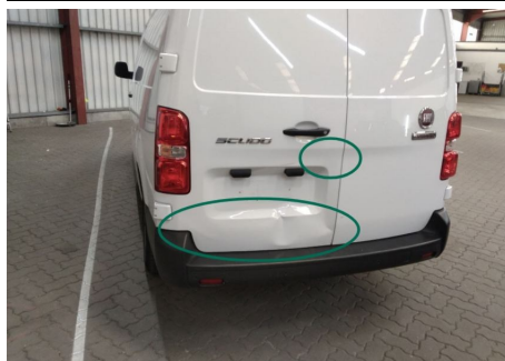
Heckklappe / Kofferraumtür / Links / Delle
