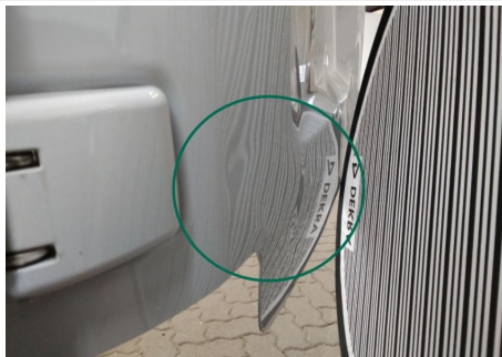
Heckklappe / Kofferraumtür / Links / Delle
