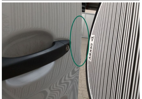
Heckklappe / Kofferraumtür / Links / Delle
