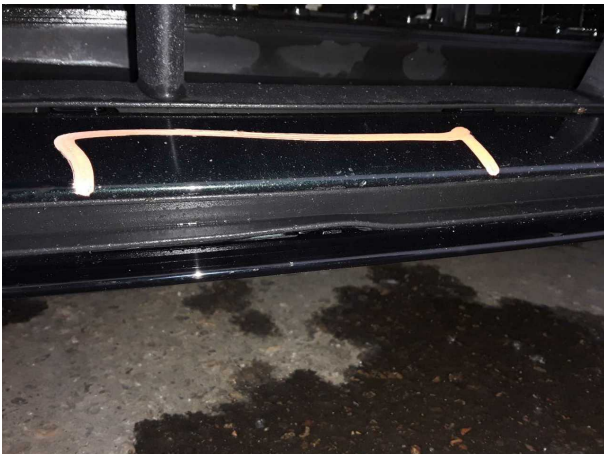
Beschädigung #1: Stossfänger vorn: Spoiler - Fehlstellung - instandsetzen
