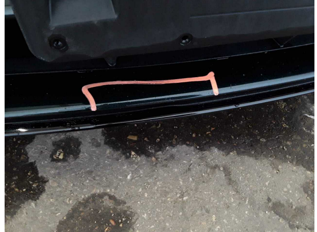
Beschädigung #1: Stossfänger vorn: Spoiler - Fehlstellung - instandsetzen
