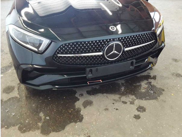
Beschädigung #1: Stossfänger vorn: Spoiler - Fehlstellung - instandsetzen
