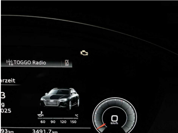
Beschädigung 1: Motor: Motor (Motorkontrolle, Kosten werden nachgereicht) - leuchtet - befunden ggf. instandsetzen
