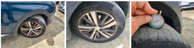
Alloy rim FR bitone/polychrome, Scratch(es), Repair/replace (lump sum)
