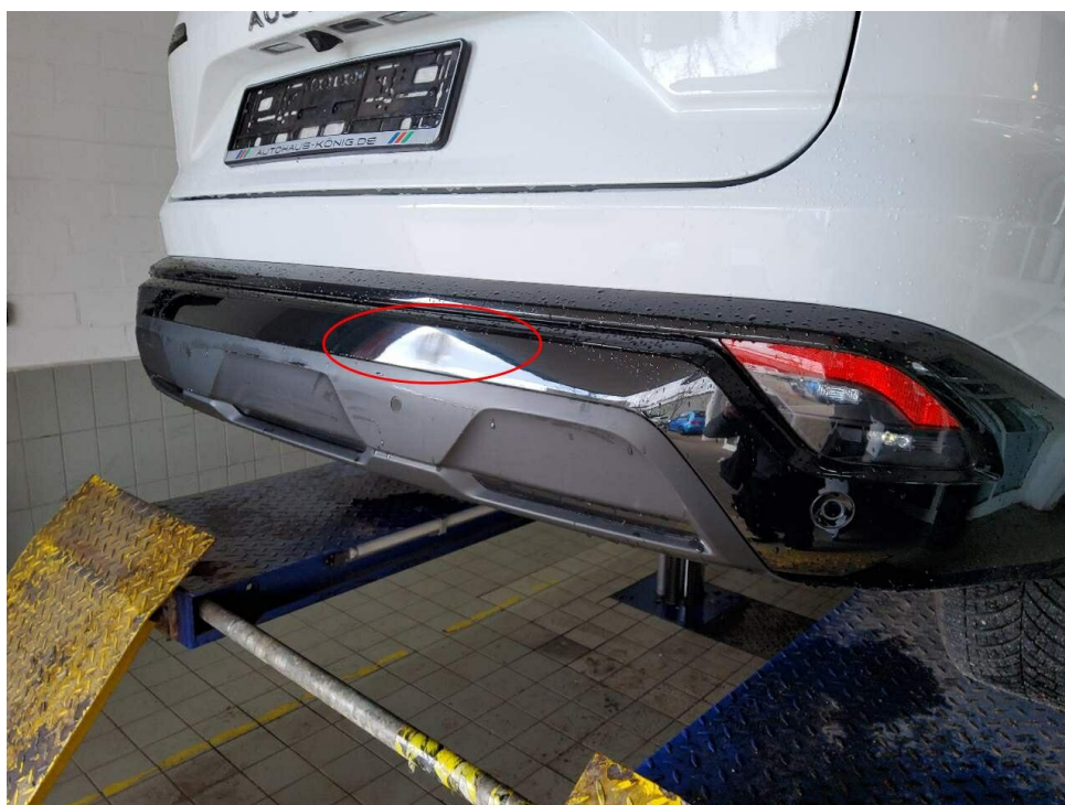
Bild 10 : Stoßfänger hinten zerkratzt
