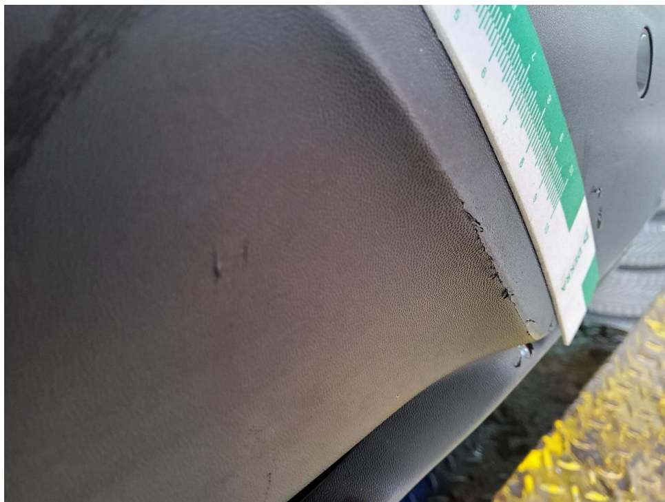
Bild 13 : Stoßfänger hinten Unterteil zerkratzt, im Verbund erneuern
